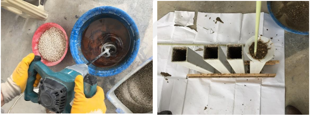
Şekil 3.11. Polimer beton üretimi ve yerleşimi
