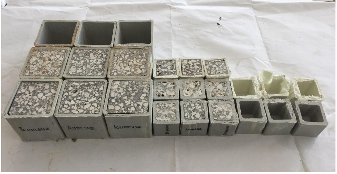
Şekil 3.20. Basınç deneyi sonrası numunelerde oluşan deformasyonlar
