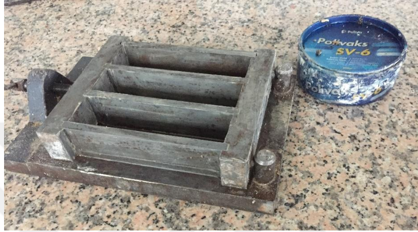
Şekil 3.3. Prizmatik numune kalıpları ve kalıp ayırıcı
