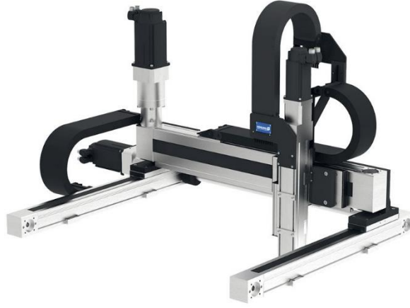
Şekil 3.10. Örnek bir kartezyen robot (Robotpark, 2015)
