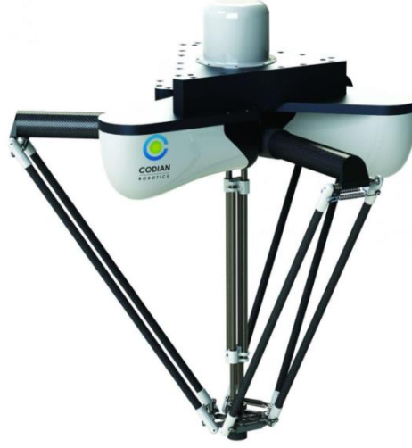
Şekil 3.8. Paralel Delta manipülatör
