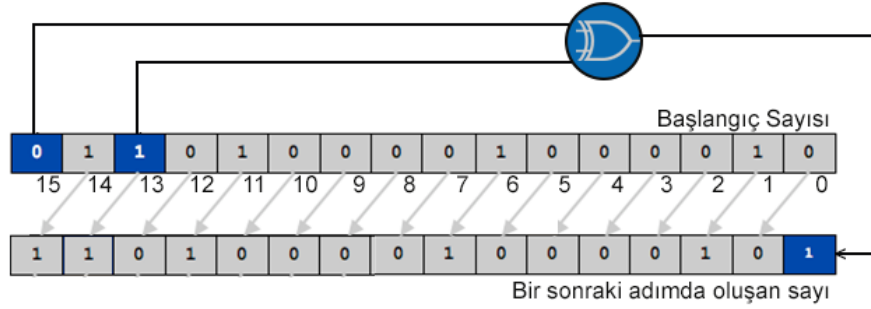
Şekil 3.61. LFSR algoritmasının uygulanması
