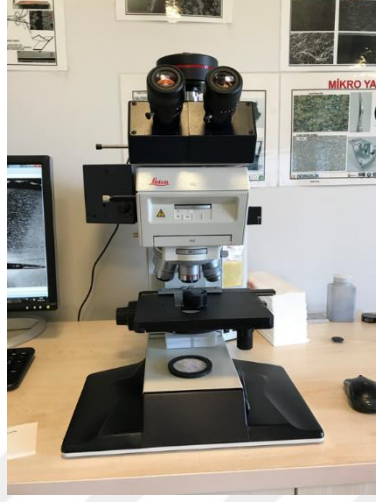
Şekil 5.9. Mikroyapı görüntülerinde kullanılan optik mikroskop.
