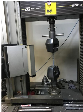
Şekil 5.8. Deneylerde kullanılan 100 tonluk Instron çekme makinesi.
