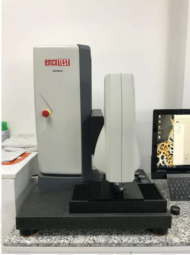
Şekil 5.11. Seri Mikrosertlik ölçümlerde kullanılan EmcoTest Cihazı.
