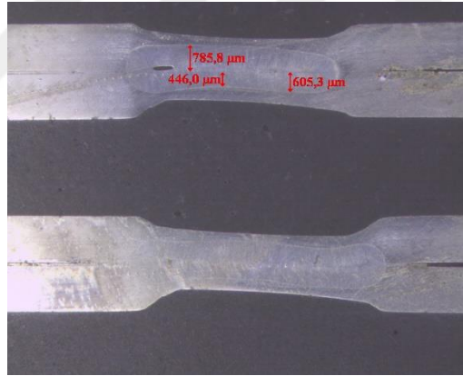
Şekil 6.43. TWIP1000 birleştirmelerinde 15 Periyot – 6,33 kA makroyapı görüntüsü.
