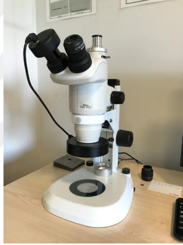
Şekil 5.9. Çekirdek boyut ölçümlerinin gerçekleştirildiği optik mikroskop.
