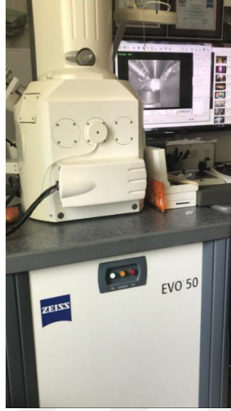
Şekil 5.10. SEM ölçümünde kullanılan Zeiss EVO 50.
