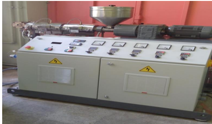
Şekil 3.15 : Medikal hortumların üretildiği ekstrüder tezgâhı.
