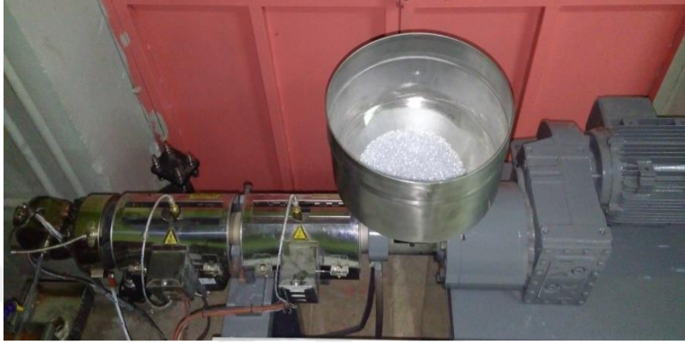
Şekil 3.21 : Medikal PVC' nin huniye doldurulması.
