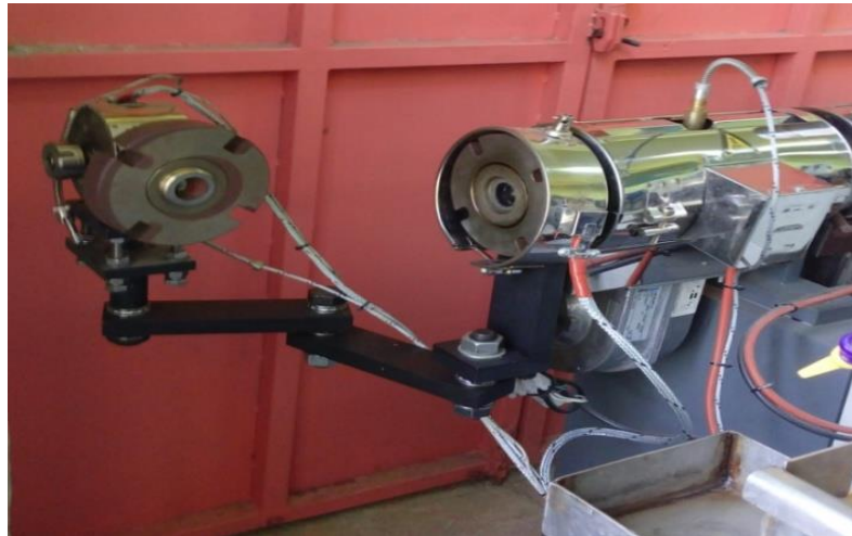
Şekil 3.18 : Vida ve kovan temizliği için ekstrüderden kalıbın sökülmesi.
