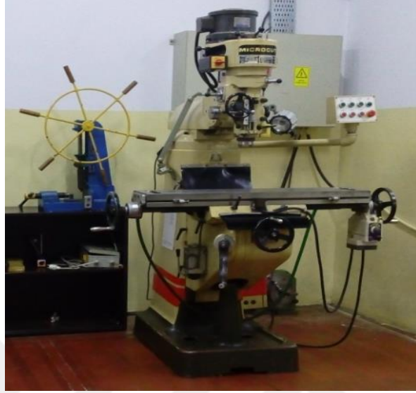
Şekil 3.7 : Kalıp üretiminde kullanılan dikey freze tezgâhı.
