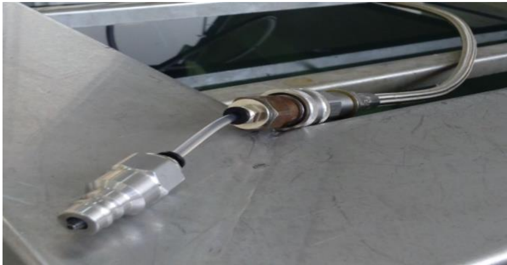
Şekil 3.33 : Hortum numunesinin bağlayıcıya montajı.
