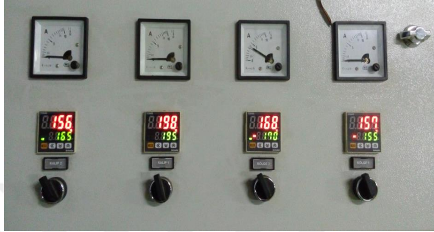
Şekil 3.25 : İdeal üretim değerlerindeki ekstrüder ve kalıp ısıları.
