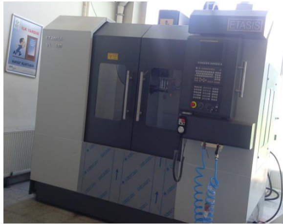
Şekil 3.8 : Kalıp üretiminde kullanılan CNC freze tezgâhı.
