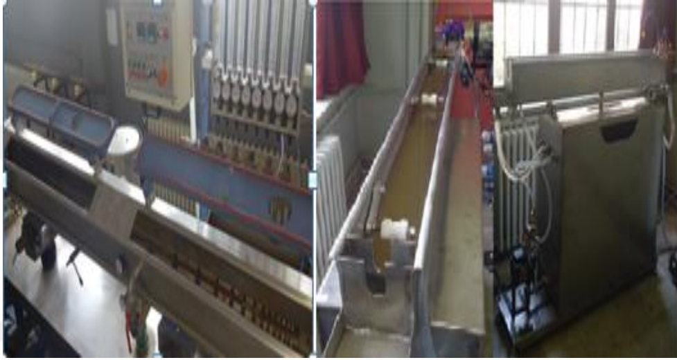
Şekil 2.24 : Ekstrüzyon hattı soğutma havuzları.
