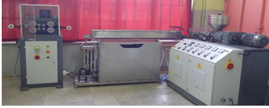
Şekil 2.3 : Yumuşak hortum ekstrüzyon üretim hattı.
