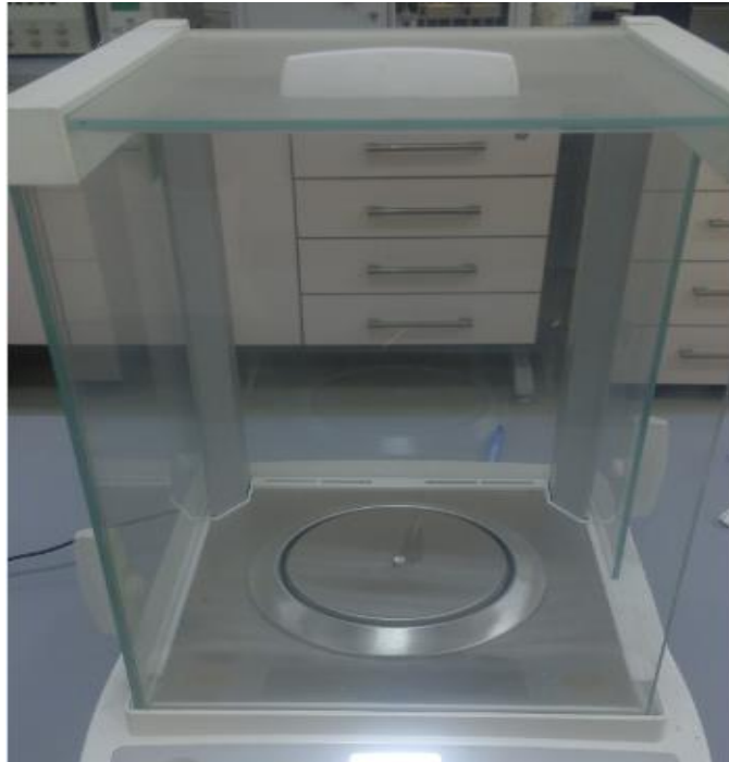
Şekil 3.35: Alüminyum pan ağırlığının hassas terazide sıfırlanması.
