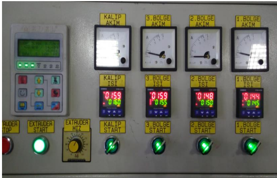
Şekil 3.22 : Düşük değerlerdeki ekstrüder ve kalıp ısıları.
