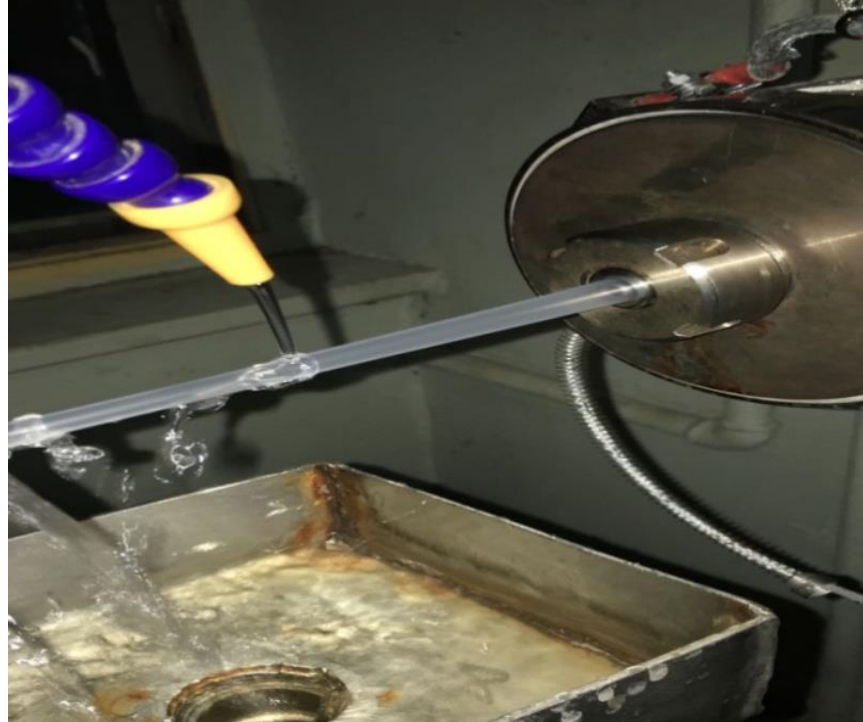
Şekil 3.26 : İdeal şeffaflıktaki hortum numunesinin kalıptan çıkışı.
