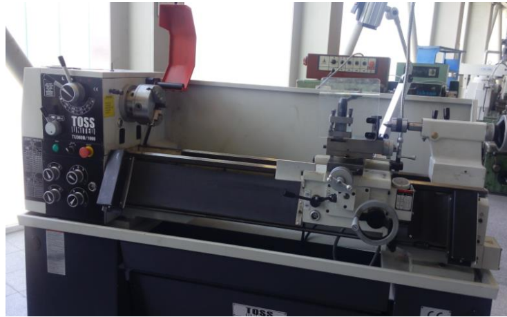
Şekil 3.5 : Kalıp üretiminde kullanılan torna tezgâhı.
