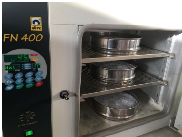
Şekil 3.20 : Medikal PVC' nin fırında kurutulması.
