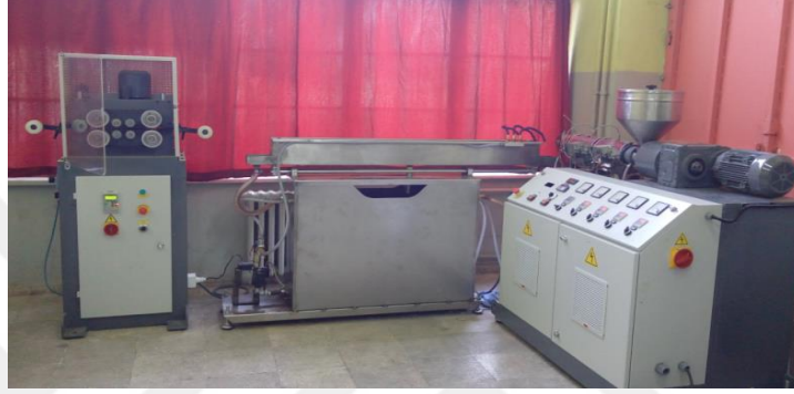
Şekil 3.14 : Medikal hortumların üretildiği plastik ekstrüzyon hattı.
