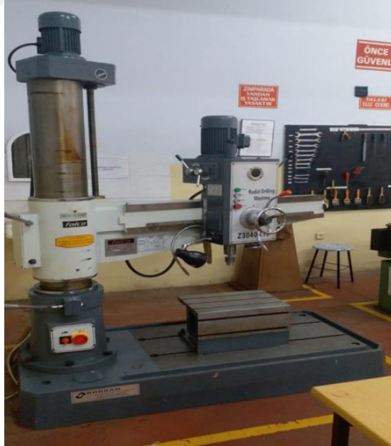
Şekil 3.13 : Kalıp üretiminde kullanılan radyal matkap tezgâhı.
