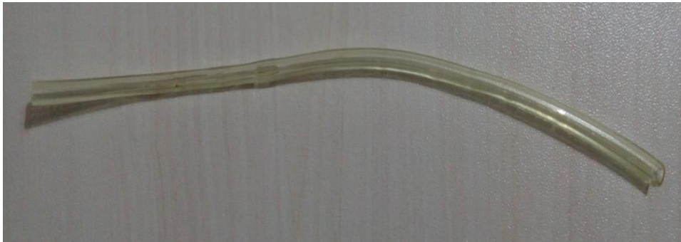
Şekil 3.24 : Yüksek ısılarda üretilen hortumdaki yanık izleri.
