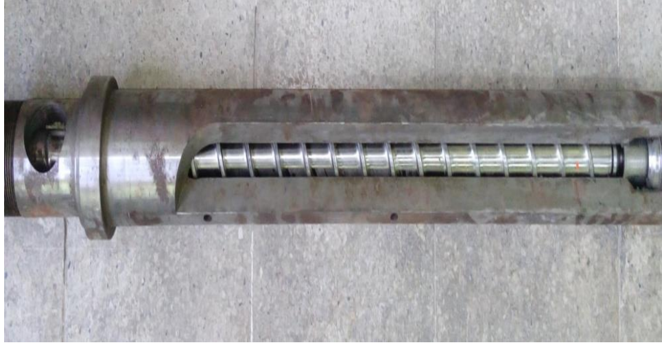
Şekil 2.13 : Vidanın kovan içerisinde yataklanması.
