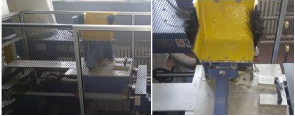
Şekil 2.28 : Ekstrüzyon hattı kesme ünitesi.
