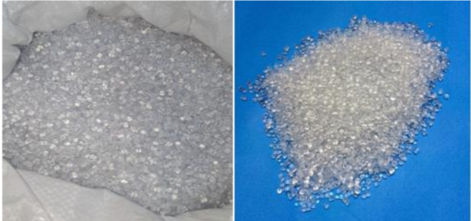
Şekil 3.1 : Tez çalışmasında kullanılan medikal PVC granülü.
