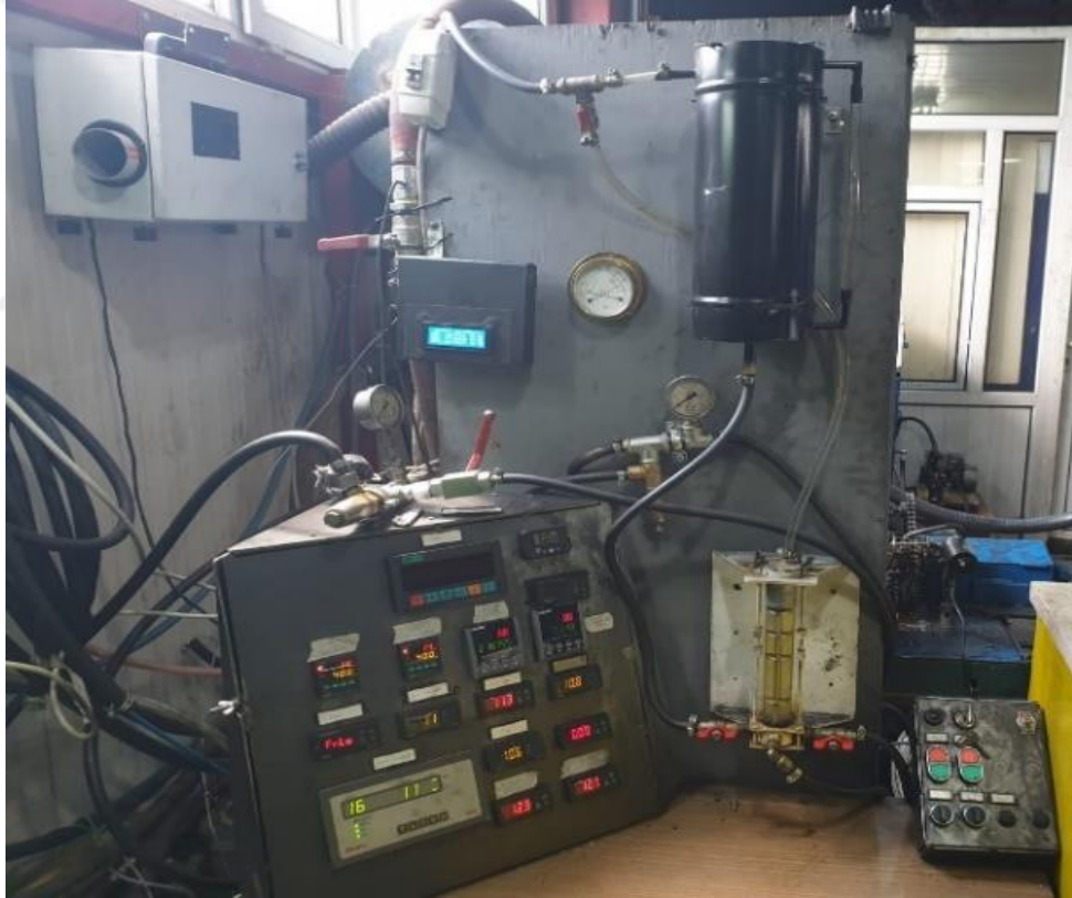
Şekil 4.4. Hava kütleli debi ölçer, bağıl nem ölçer, yakıt deposu.
