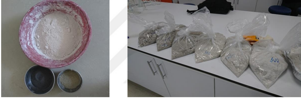
Şekil 5.6: Karışımların hazırlanması numunelerin hava almayacak şekilde bekletilmesi(minimum 16 saat) (TS 1900-1, 2006).
