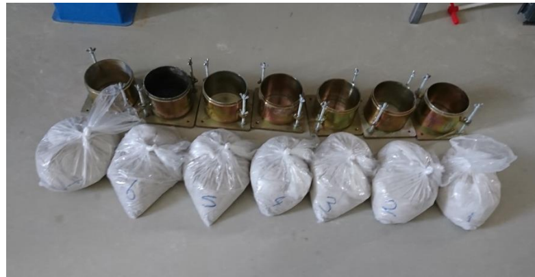
Şekil 5.11: Karışımların hazırlanması ve zeminin hava almayacak şekilde bekletilmesi(minimum 24 saat) (TS 1900-2, 2006).
