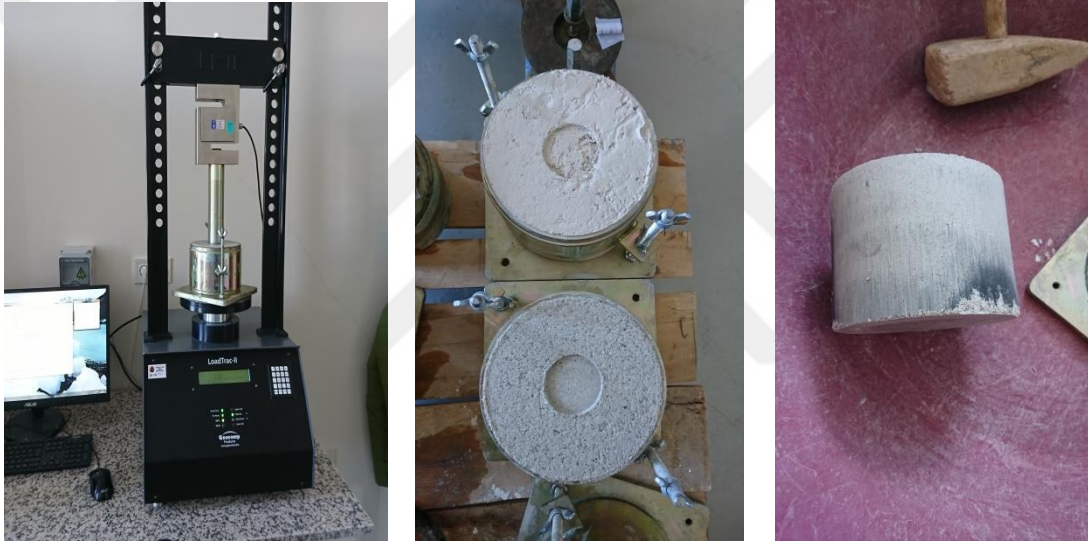
Şekil 5.13: CBR deneyini 2. Aşaması test ve test sonucu numunelerin durumu.
