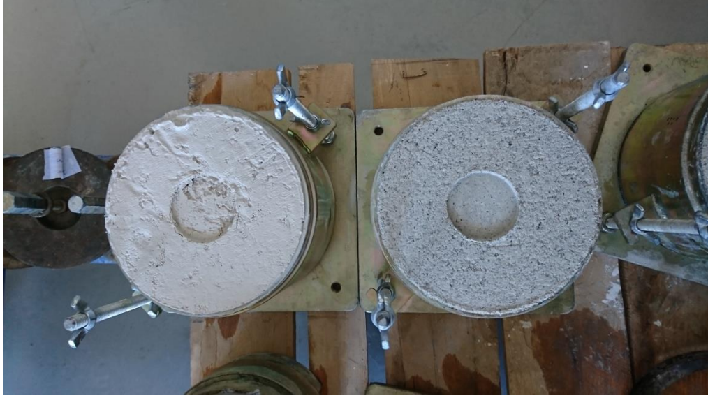
Şekil 6.5. 28 günlük kür sonucu CBR testi yapılan 1(sol) ve 7(sağ) nolu karışımlar.
