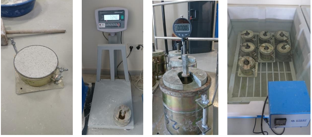
Şekil 5.12: CBR deneyi 1. aşaması sıkıştırma ve kür işlemleri
