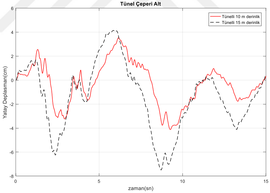
Şekil 7.32. Sıvılaştırma modelinde farklı derinliklerdeki tünellerde tünel çeperi yatay deplasman sonuçları a) üst nokta b) alt nokta
