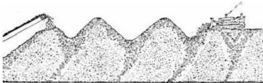
Őekil 3.12. Yıđının hazırlanması sırasında ince ve iri tanelerin ayrıřmaya uđraması (Girginc, 1989).
