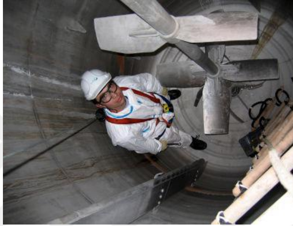
Şekil 3.11. Karıştırmalı liç tankı (McClelland ve Hill,1981).
