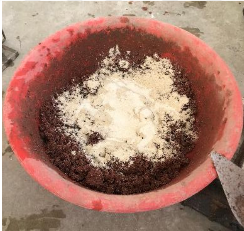
Şekil 3.15. Standart horasan harcına taş tozu eklenmesi.
