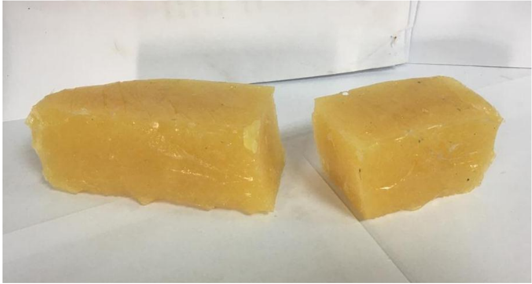
Şekil 4.48. Eğilme deneyi sonrası epoksi numune.
