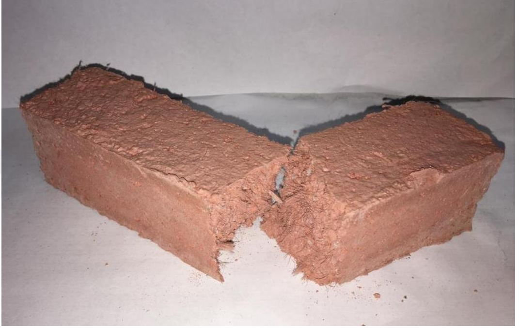
Şekil 4.38. Kırılmış cam lifli takviyeli numune.
