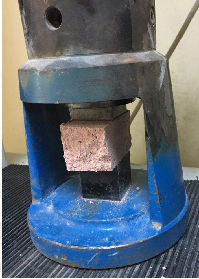
Şekil 3.25. Basınç deney düzeneği.
