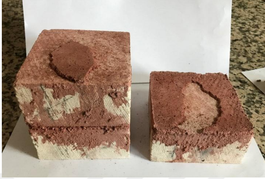
Şekil 4.9. Kesme numunelerinin kırılma şekilleri.
