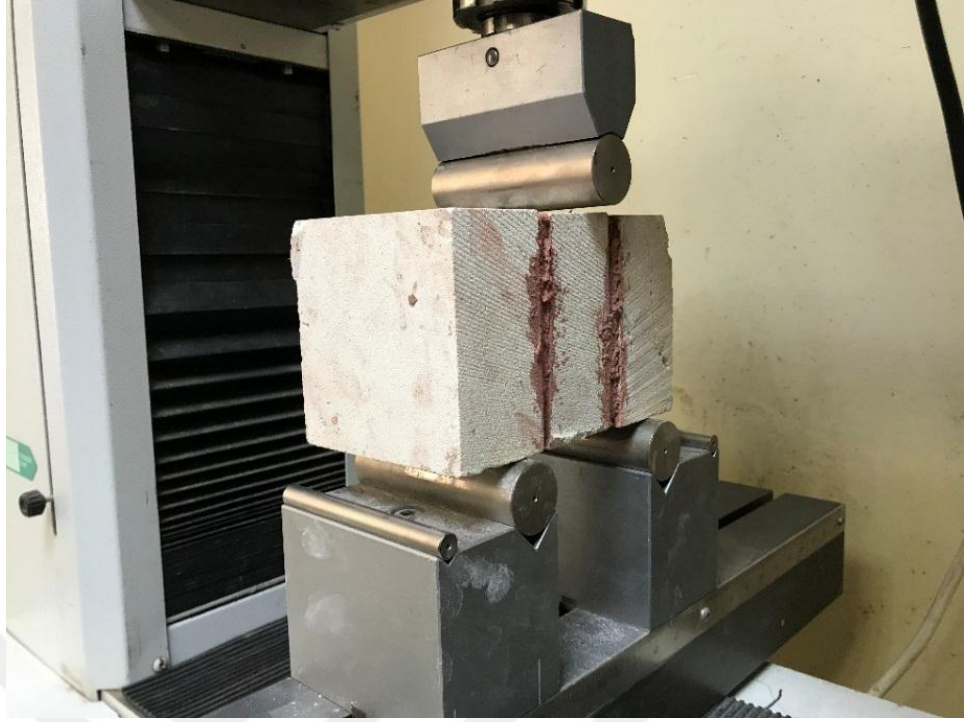
Şekil 3.26. Kesme deney düzeneği.
