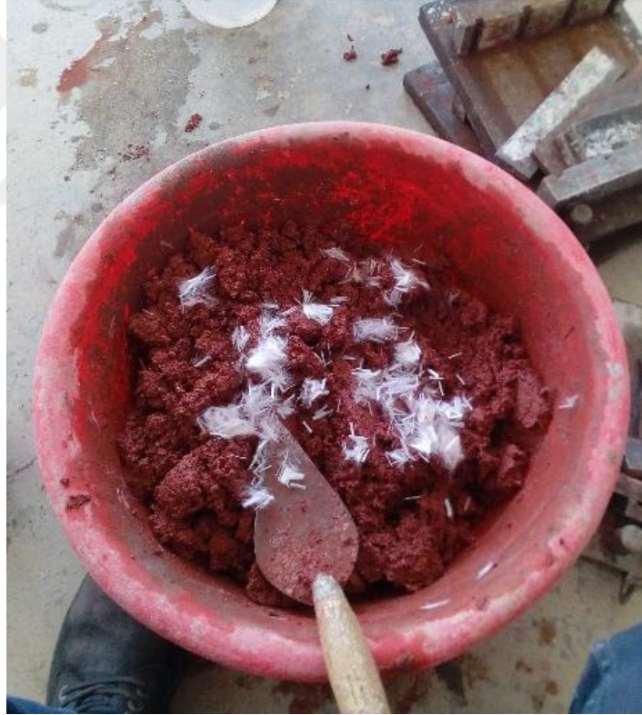
Şekil 3.16. Standart horasan harcına cam lifi eklenmesi.
