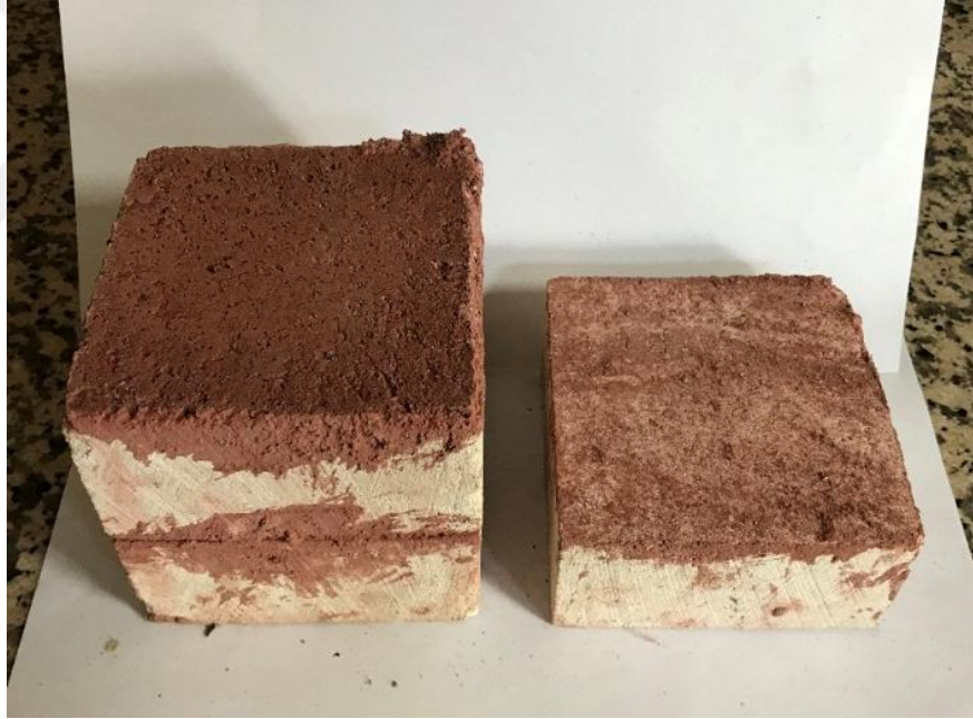
Şekil 4.10. Kesme numunelerinin kırılma şekilleri.
