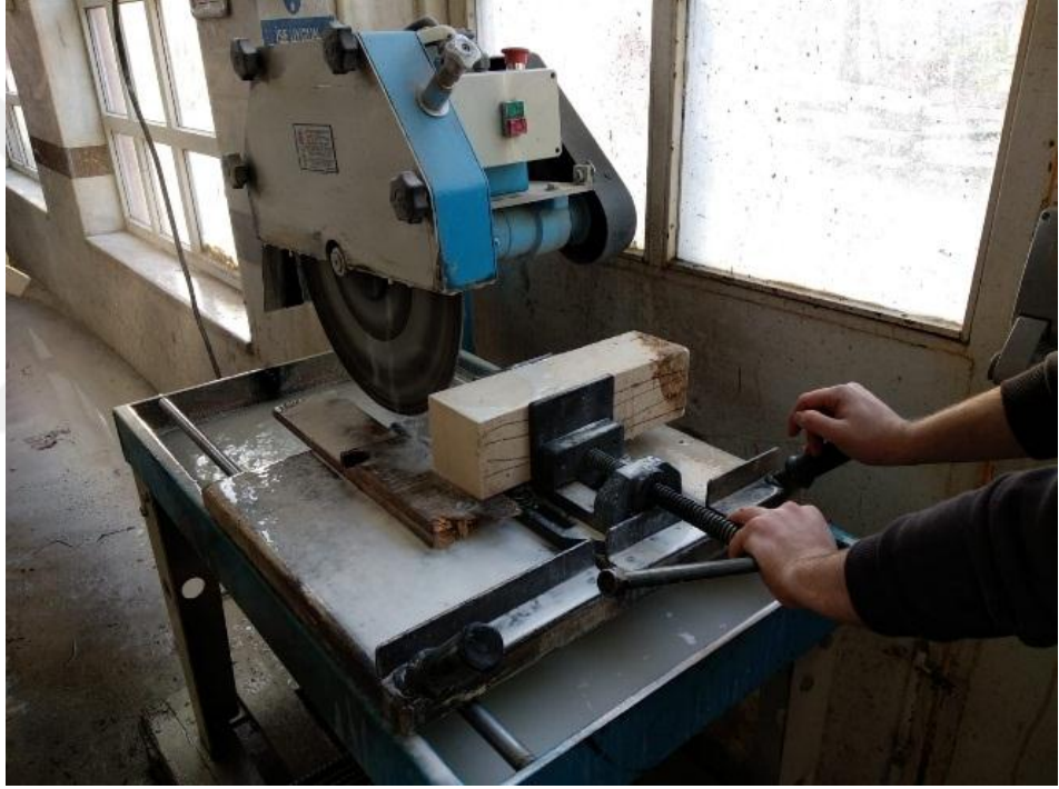
Şekil 3.6. Taşların kesim makinesinde kesilerek deneylere hazır hale getirilmesi.
