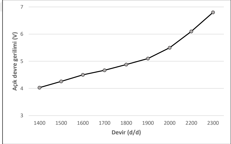
Şekil 6.3. Yüksüz motor devir – açık devre gerilimi değişimi.
