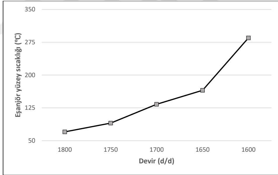
Şekil 6.7. 1800 d/d'dan yüklü motor devir – eşanjör yüzey sıcaklığı deęişimi.
