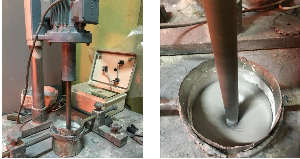
Şekil 5.2. Dikey tip karıştırma makinası
