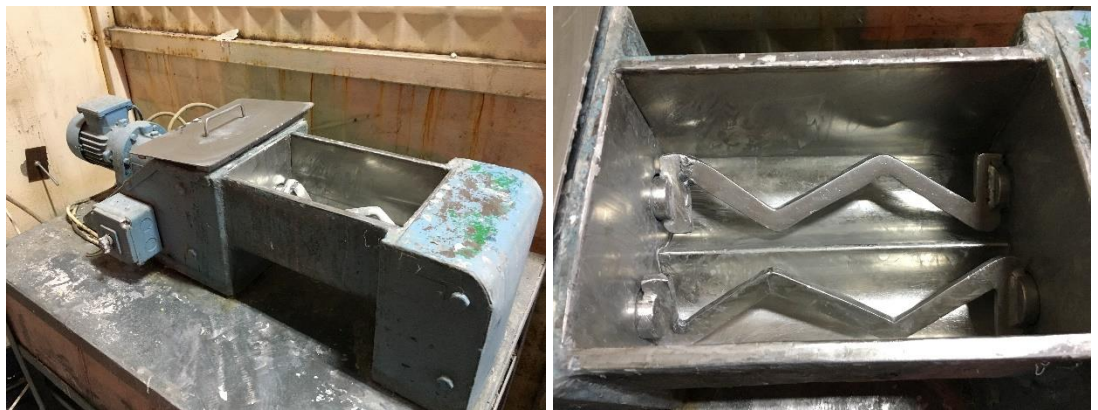
Şekil 5.3. Yatay karıştırıcı ve bıçakları
