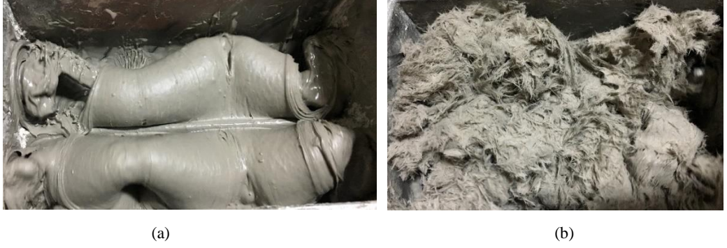
Şekil 5.7. (a) Kaolen katıldıktan sonra BMC hamur kıvamı, (b) 6mm kırpıntı cam elyaf katıldıktan sonra Kaolen dolgulu 006 BMC hamur görüntüsü
