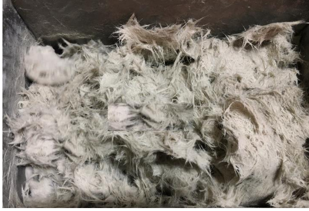
Şekil 5.11. Barit dolgulu yanmaz hamura kırpıntı cam elyaf katıldıktan sonraki görüntüsü
