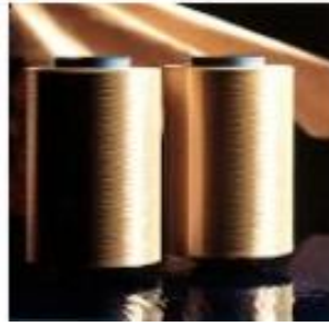
Şekil 3.7. Aramid Elyaf Lifi (Işık, 2008).
