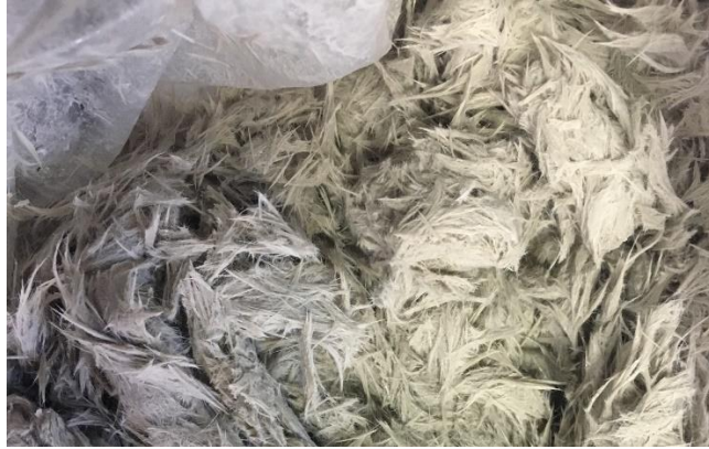
Şekil 5.10. 6mm kırpıntı cam elyaf katıldıktan sonra Barit dolgulu 006 BMC hamur görüntüsü
