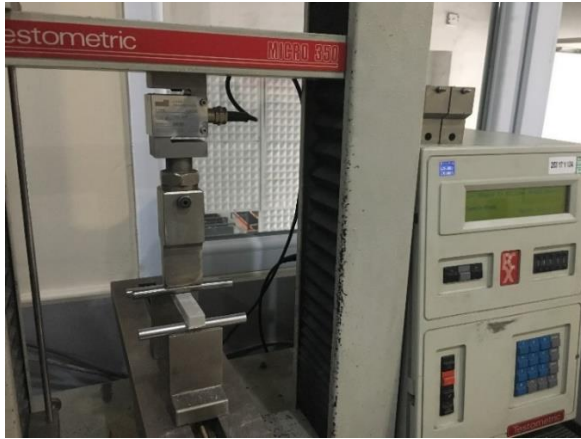
Şekil 5.31. 3 nokta eğme testi
