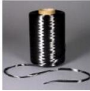
Şekil 3.6. Karbon elyaf lifi (Işık, 2008).
