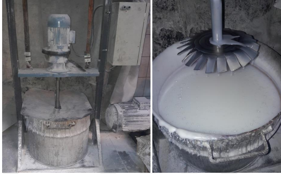
Şekil 5.1. Polystiren çözeltisi hazırlamada kullanılan dikey karıştırıcı
