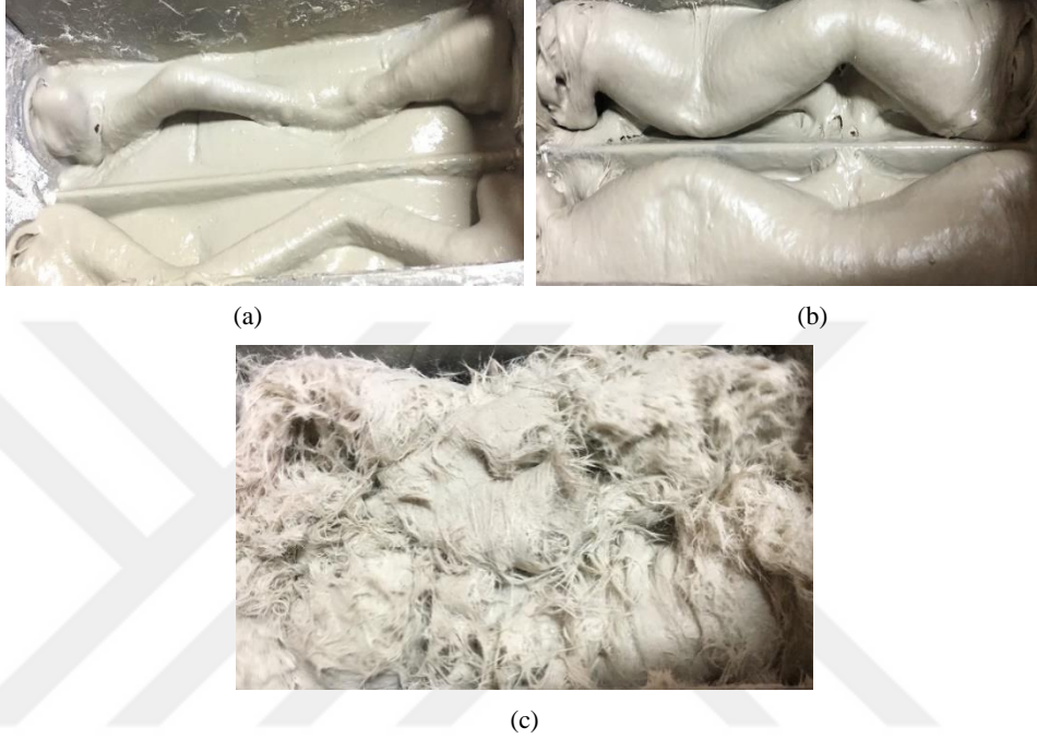
Őekil 5.21. İlk dolgu barit (1484gr-%30), (b) İkinci dolgu kalsit (1384gr-%28), (c) 12mm kırpıntı cam elyaf katılan kombinasyon son hal
