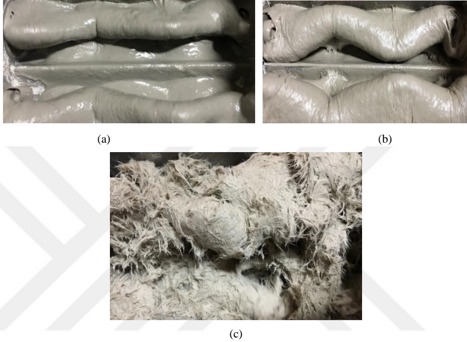
Şekil 5.18. (a) İlk dolgu kaolen (600gr-%12), (b) İkinci dolgu barit (1900gr-%38), (c) 12mm kırpıntı cam elyaf katılan kombinasyon son hal
