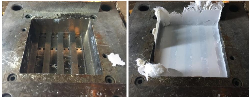
Şekil 5.27. 3 nokta eğme test çubuğunun BMC pres kalıbında basımı
