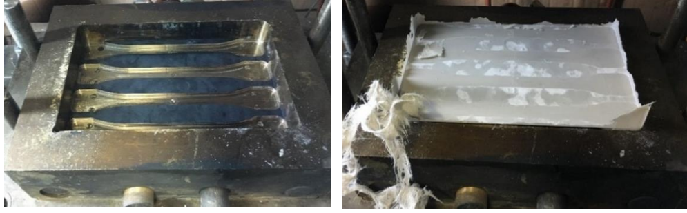
Şekil 5.25.Çekme test çubuğunun BMC pres kalıbında basımı
