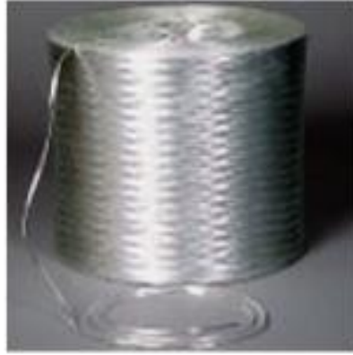
Şekil 3.5. Cam elyaf lifi (Işık, 2008).
