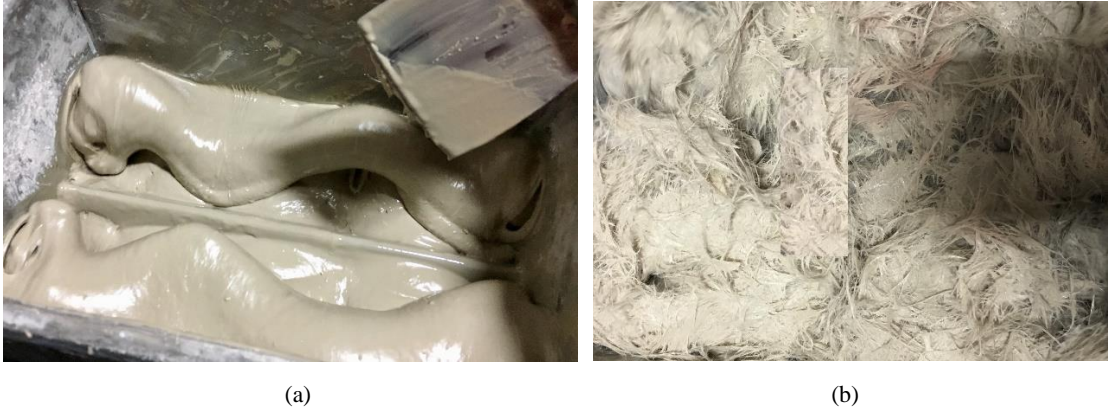
Şekil 5.9. (a) Barit katıldıktan sonra BMC hamur kıvamı, (b) 12mm kırpıntı cam elyaf katıldıktan sonra Barit dolgulu 012 BMC hamur görüntüsü
