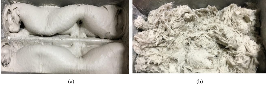
Şekil 5.8. (a) Kaolen katıldıktan sonra BMC hamur kıvamı, (b) Kaolen dolgulu yanmaz hamura kırpıntı cam elyaf katıldıktan sonraki görüntüsü
