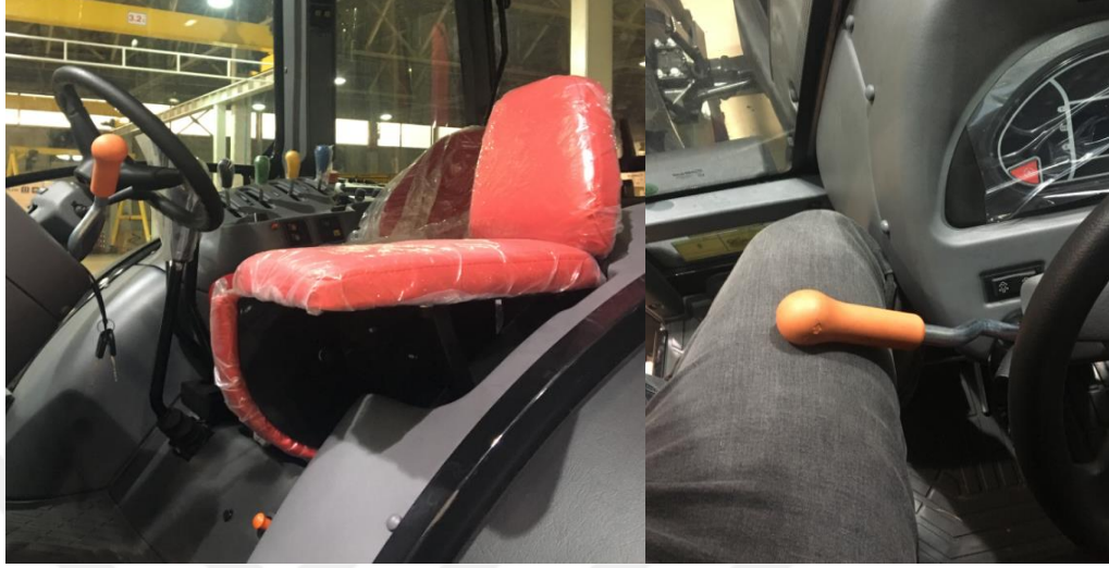
Şekil 3.38. Hostes koltuğunda yolcu olduğunda shuttle kolunun orta konumdaki görünüşü
