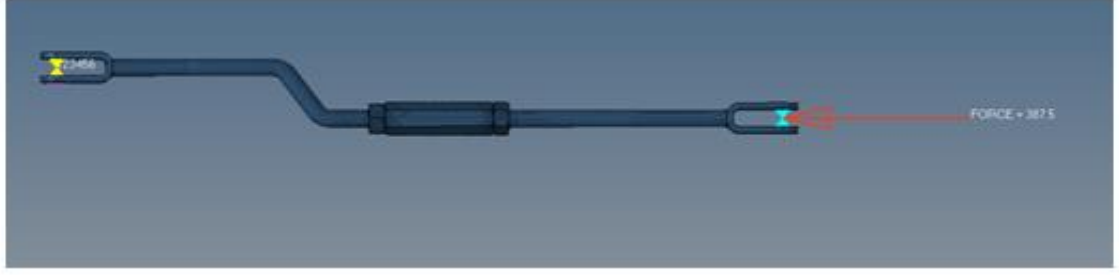
Şekil 3.30. Debriyaj üst ayar çubuğu için sınır koşullarının uygulanması.
