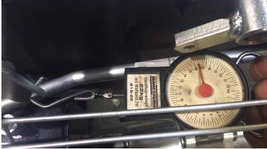
Şekil 3.56. Shuttle levyesinin ileri-geri hareketi için kuvvet ölçümü.
