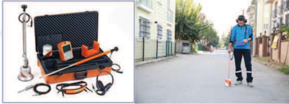
Şekil 3.12: Yer mikrofonu ve uygulaması.
