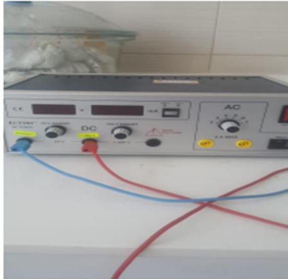
Şekil 5.6 : Elektriksel güç kaynağı.
