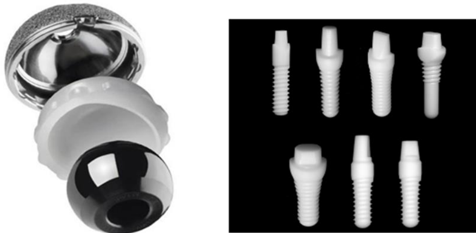
Şekil 2.10 : Zirkonya kullanılan a) kalça protezi (Russell ve Lee, 2005), b) Dental vidalar (Murr, Gaytan, Martinez, Medina, Wicker, 2012).
