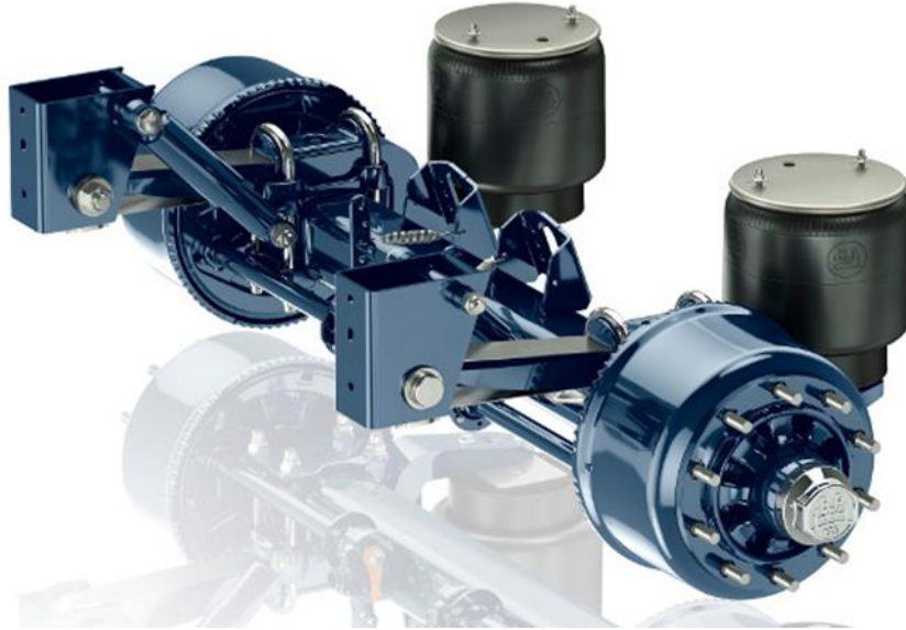
Şekil 2.20. BPW marka hava körukleri, süspansiyon ve dingil (BPW, 2019).
