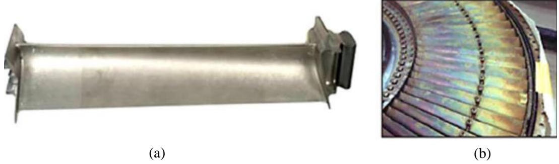
Şekil 2.4 : (a) GENx motorunda kullanılan TiAl alaşımından yapılmış düşük basınçlı türbin kanat fotoğrafı, (b) düşük basınçlı türbin kanatlarının montaj resmi (Bewlay ve diğerleri, 2016).
