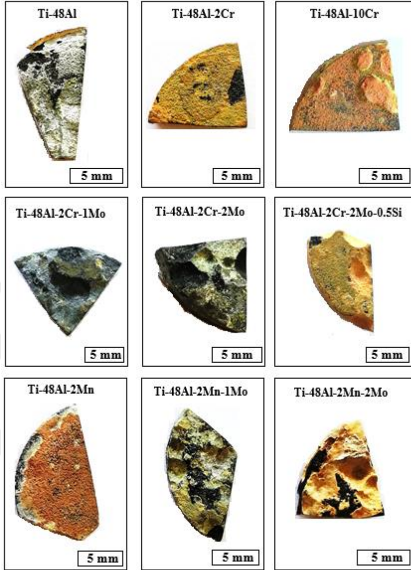
Şekil 6.47 : 900°C’de 180 saat \text{Na}_2\text{SO}_4\text{-K}_2\text{SO}_4 ortamına maruz bırakılmış numunelerin yüzey görünümleri
