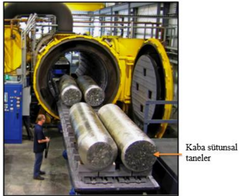
Şekil 2.24 : Homojenizasyon işlemi uygulanan kaba sütunsal taneli TiAl ingotlar (Kothari ve diğerleri, 2012).
