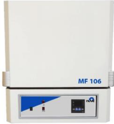
Şekil 5.4 : Oksidasyon ve sıcak korozyon testlerinin gerçekleştirildiği elektrik direnç fırını
