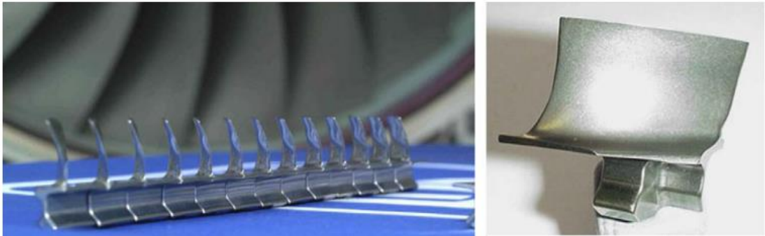
Şekil 2.23 : Rolls-Royce için ekstrüzyon ve dövme yöntemi kullanılarak Ti-45Al-8Nb-0.5(B,C) (at.%) alaşımından üretilen türbin bıçakları (Lapin, 2009).
