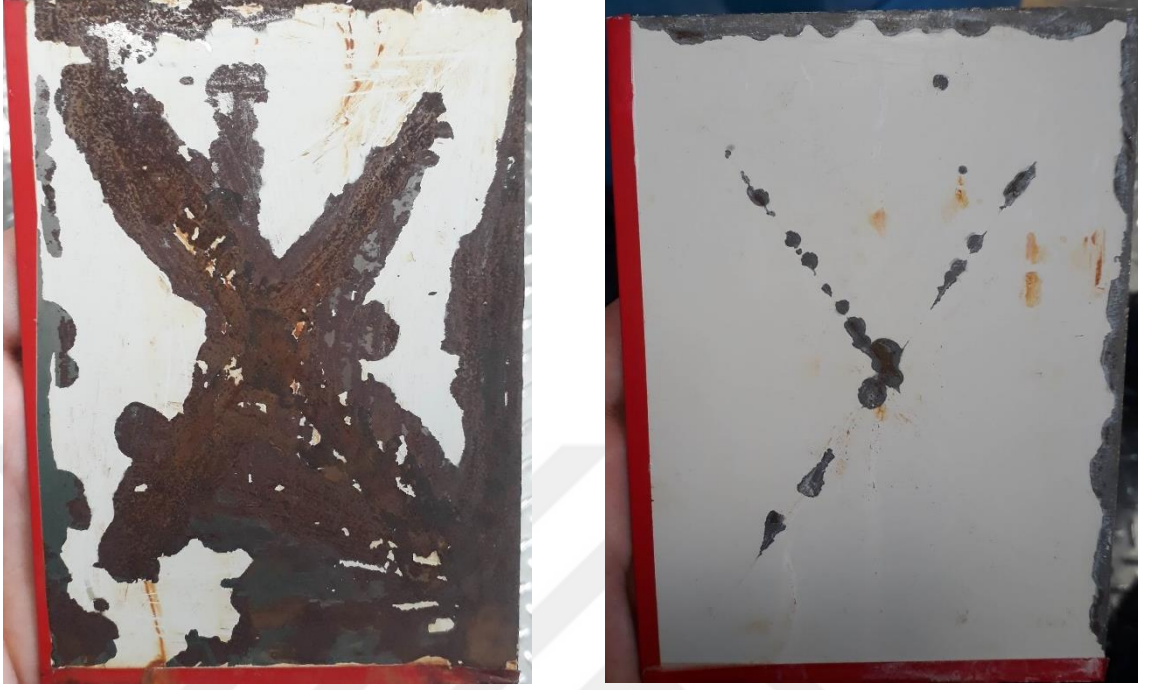
Şekil 4.26: ISO 20340 standardına göre 500 saat tuz testi uygulanmış ve yüzeyi kazınmış sırasıyla DC01 DX51 malzemelerin yüzey görüntüleri
