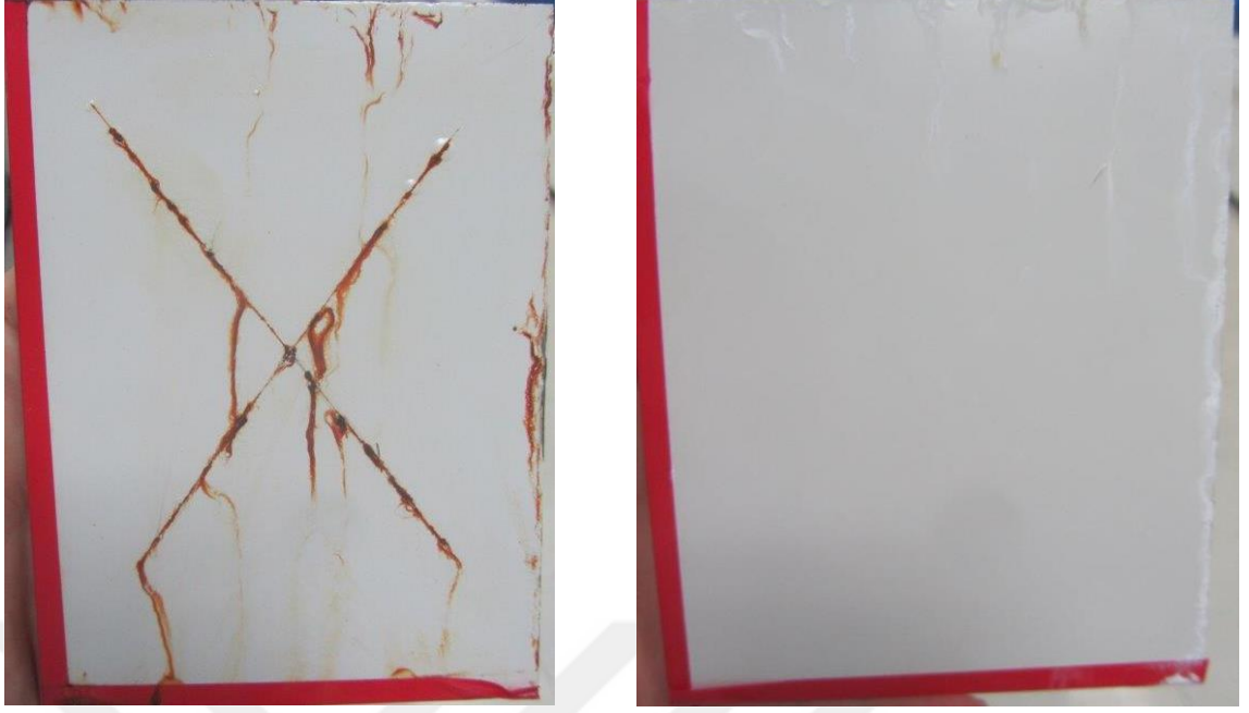
Şekil 4.24: ISO 20340 standardına göre 250 saat tuz testi uygulanmış sırasıyla DC01, DX51 malzemelerin yüzey görüntüleri
