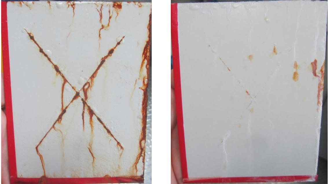
Şekil 4.25: ISO 20340 standardına göre 500 saat tuz testi uygulanmış sırasıyla DC01 DX51 malzemelerin yüzey görüntüleri
