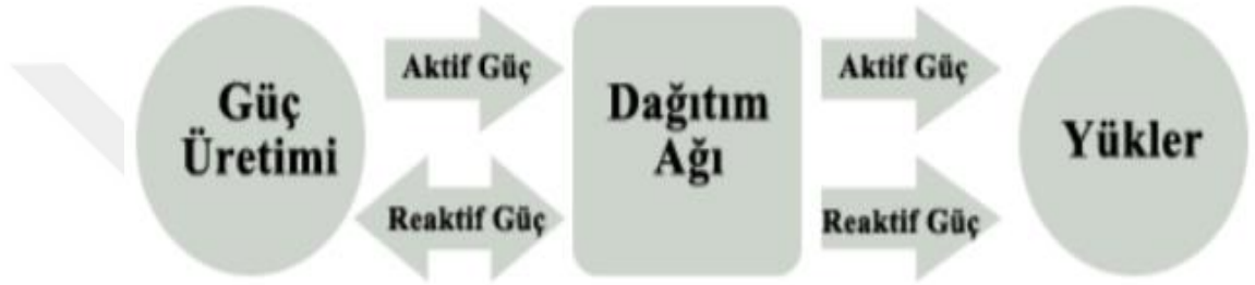
Şekil 2.6: Kompanzasyondan önce sistemde güç dolaşımı
