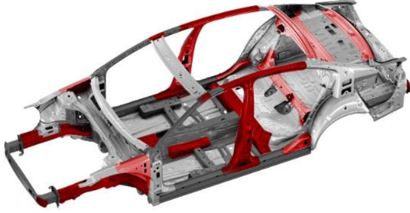
Şekil 3.4 : Çift fazlı çeliklerin otomobillerde kullanıldığı yerler [29].
