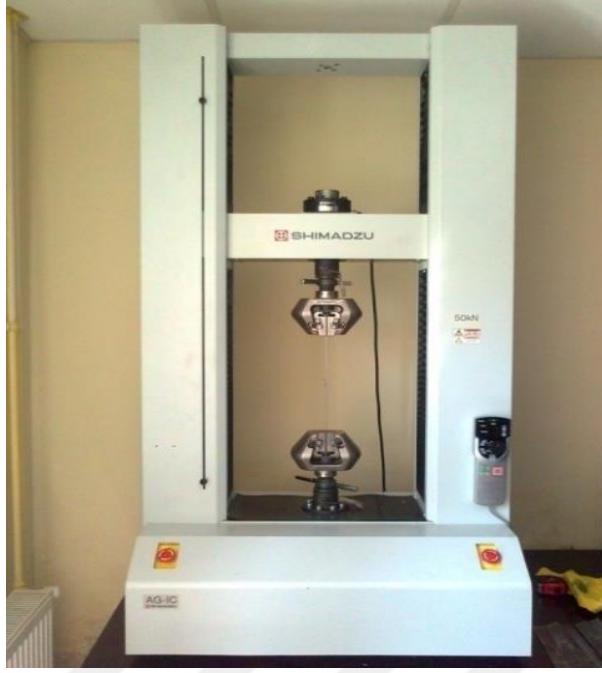
Şekil 6.14 : Deneylerde kullanılan çekme cihazı.
