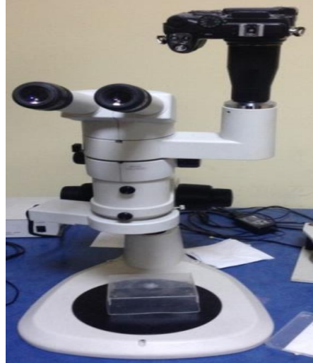
Şekil 6.17 : Makroyapı incelemelerinde kullanılan optik mikroskop.
