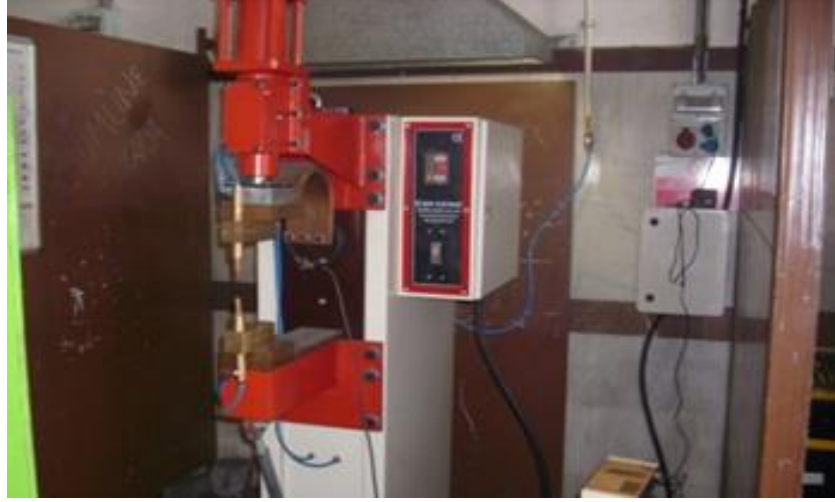
Şekil 6.5 : Deneylerde kullanılan elektrik direnç nokta kaynağı makinesi.
