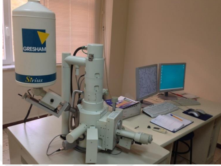
Şekil 6.16 : Mikroyapı incelemelerinde kullanılan taramalı elektron mikroskobu (SEM).
