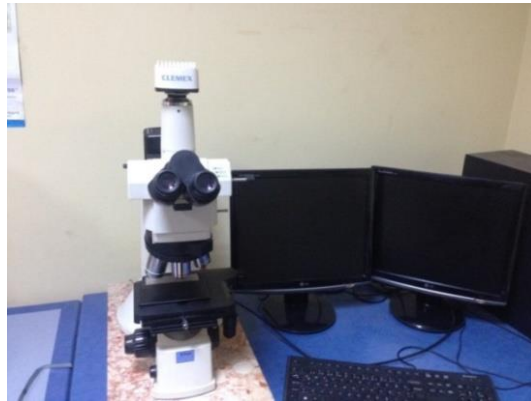
Şekil 6.15 : Mikroyapı incelemelerinde kullanılan optik mikroskop.
