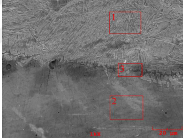
Şekil 7.68 : TWIP-DP bağlantılarda çekirdek-ITAB ara bölgeye ait EDS görüntüsü.
