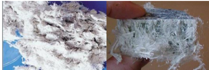
Şekil 2.11: Krizotil (beyaz asbest) [16]
