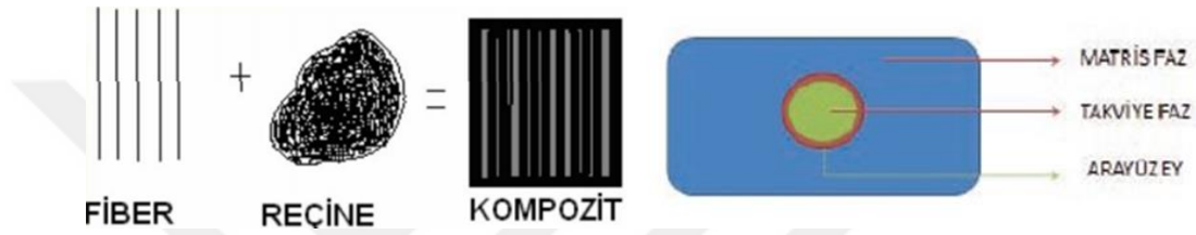
Şekil 2.1: Kompozit malzemelerde bulunan yapıların şematik gösterimi [11]
