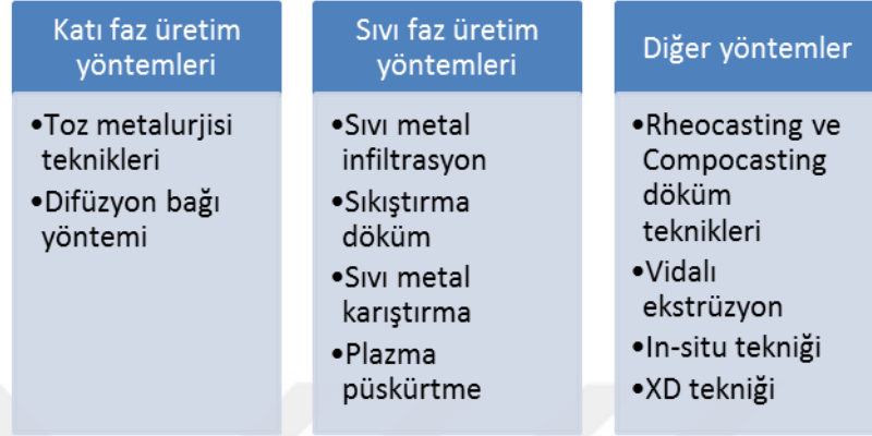
Şekil 2.23: MMK malzemeler üretim yöntemlerinin şematik gösterimi [26]
