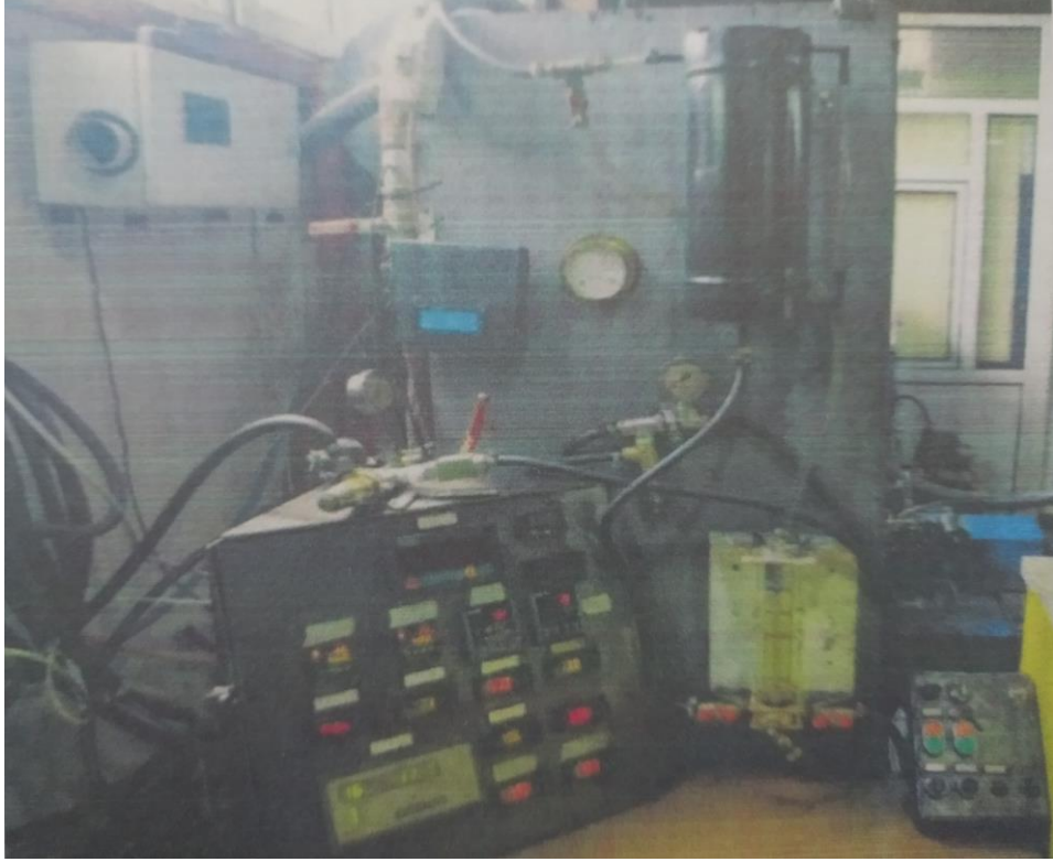
Şekil 4.1.8. Hava kütlesel debi ölçer, bağıl nem ölçer.
