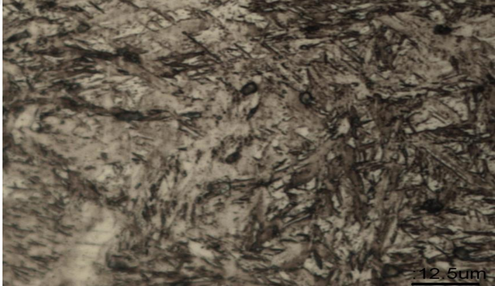
Şekil 6.22: 200x büyütmede sementasyon yapılmış 20MnCr5 çeliğinin kesitinden alınan mikroyapı görüntüsü
