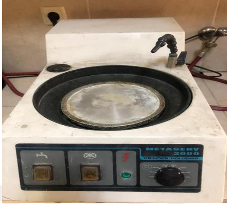
Şekil 5.4. Metaserv2000 grinder/polisher marka zımpara ve parlatma cihazı.
