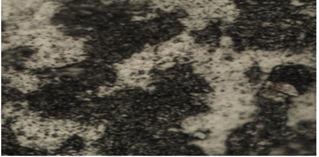
Şekil 6.18: 500x büyütmede sementasyon yapılmamış 20MnCr5 çeliğinin mikroyapı görüntüsü
