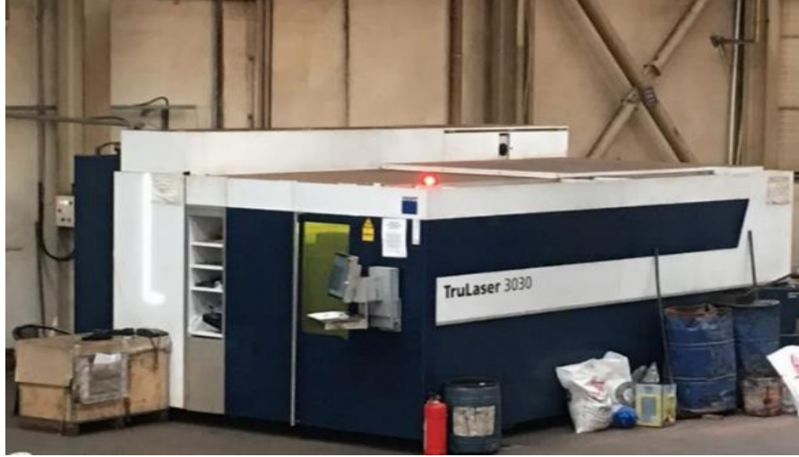
Şekil 5.2. Truelaser3030 Lazer kesim Makinası.
