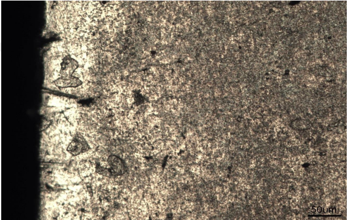
Şekil 6.13: 100x büyütmede 600°C'de 2 saat temperlenmiş hardox450 çeliğinin kesitinden alınan mikroyapı görüntüsü
