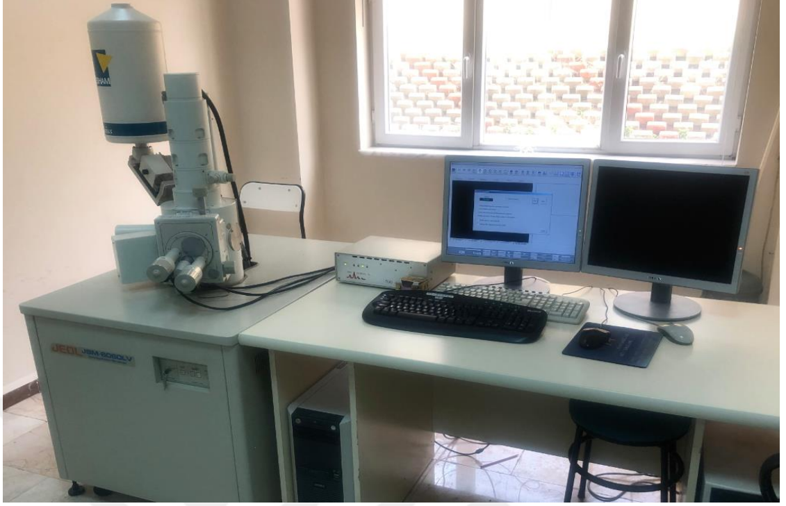
Şekil 5.5: JEOL JSM 6060LV SEM ve IXRF Systems Inc.500 Digital Processing markalı EDS cihazı
