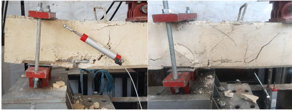
Şekil 4.2. Kontrol kirişin yükleme sonrası deformasyon şekli.
