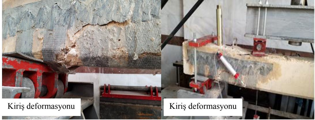
Şekil 4.10. USBA90 kiriş numunesinin yükleme sonrası deformasyon şekilleri.
