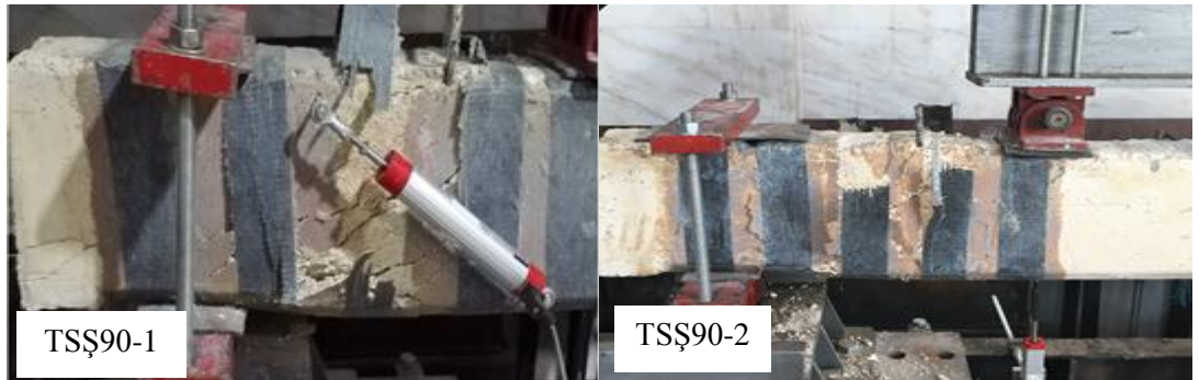
Şekil 4.14. TSS90 kiriş numunelerinin yükleme sonrası deформasyon şekilleri.
