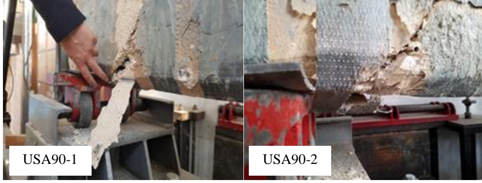
Şekil 4.6. USA90 kiriş numunelerinin yükleme sonrası deformasyon şekilleri.
