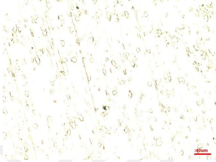
Şekil 6.1: 1000 °C'de 2 saat süreyle sinterlenmiş Ti mikro yapısının görüntüsü (100x büyütme)
