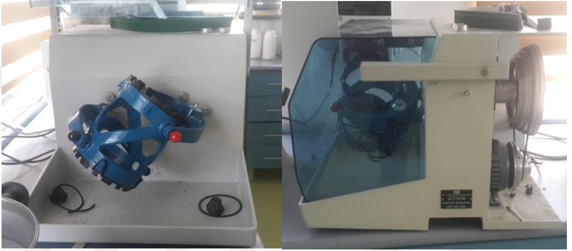
Şekil 5.1: Kompozit bileşimlerinin hazırlanmasında kullanılan karıştırıcı Turbula Mikser
