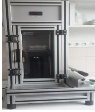
Şekil 5.2: Homojen kompozit toz karışımlarını kompaktlamak için kullanılan manuel presleme cihazı
