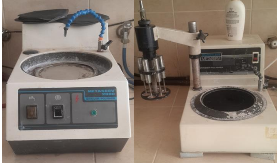
Şekil 5.4: Metaserv 2000 grinder/polisher zımparalama cihazı ve buehler metaserv grinder/polisher parlatma cihazı
