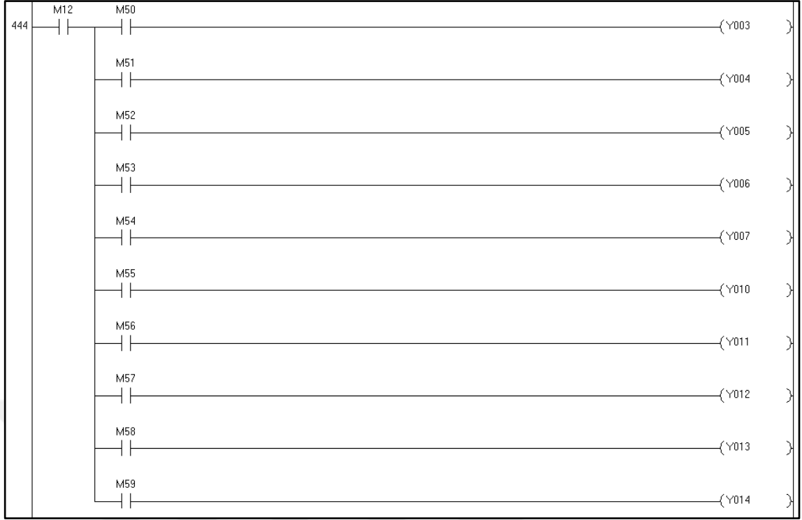
Şekil 4.8. Hareketli köprülerin hareketini sağlayan çıkışların M bitleri ile sürülmesi.
