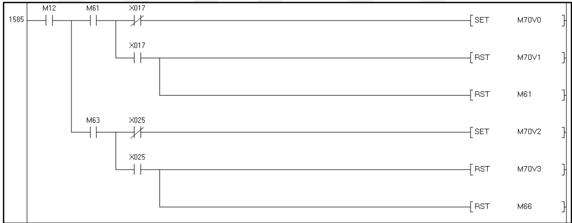
Şekil 4.31. Şasilerin zımpara prosesinden macun prosesine transferi.
