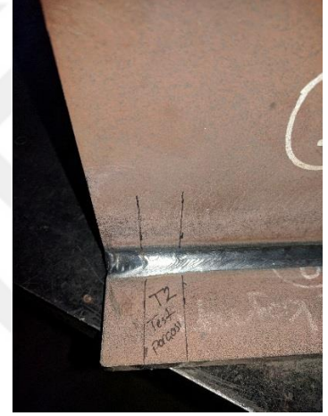
Köşe kaynak birleşimli parçadan test numunelerinin belirlenmesi
