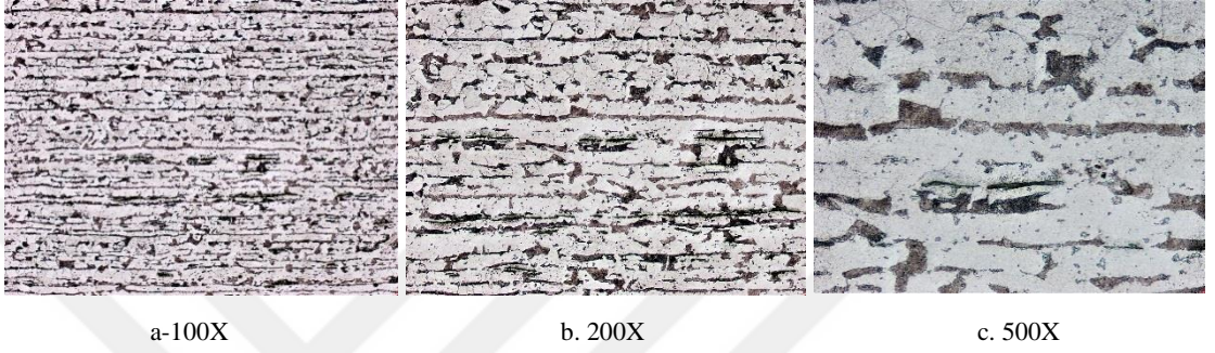
Şekil 6.26. HEA300-HEA300 Alın kaynaklı birleşim ana metal bölgesi mikro yapı görüntüleri
