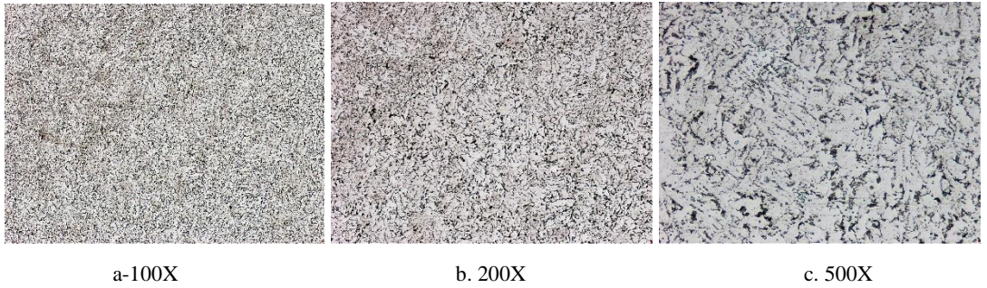
Şekil 6.28. HEA300-HEA300 Alın kaynaklı birleşim kaynak metal bölgesi mikro yapı görüntüleri
