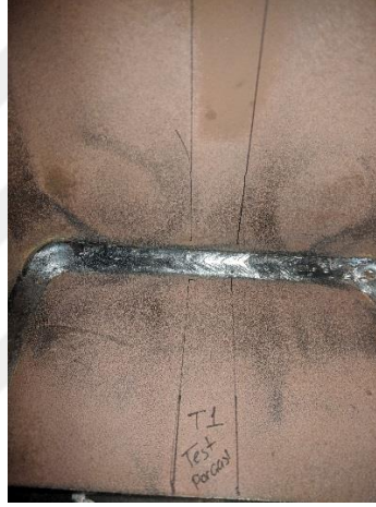
Köşe kaynak birleşimli parçadan test numunelerinin belirlenmesi
