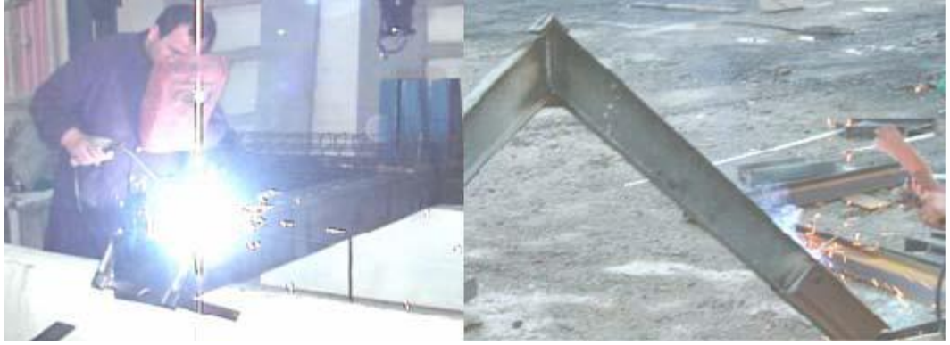
Şekil 3.8. Elektrot kaynağında arkın oluşumu (Tama, 2016)
