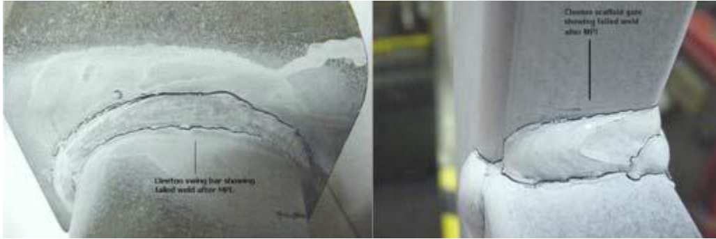
Şekil 3.2. Kaynaklı birleşimlerde hasar oluşumları (Tama, 2016)
