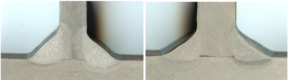
Şekil 6.25. HEA200-10mm plaka köşe kaynaklı birleşimler için makro yapı incelemesi
