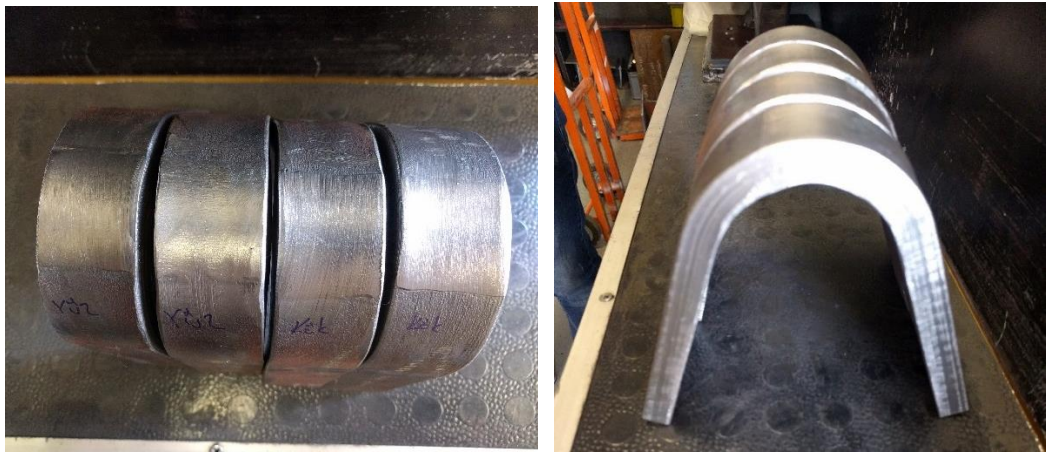
Şekil 6.16. Eğme testi sonrası parçaların yüzeyleri
