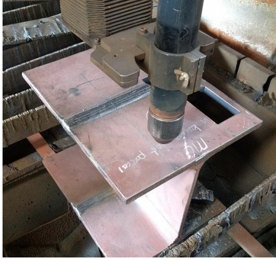
Alın kaynak birleşimli parçanın flanş ve gövdesinden test numunelerinin alınması
