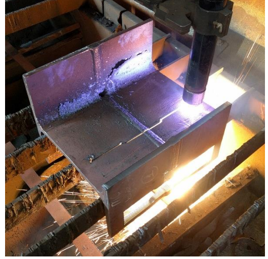
Alın kaynak birleşimli parçanın flanş ve gövdesinden test numunelerinin alınması
