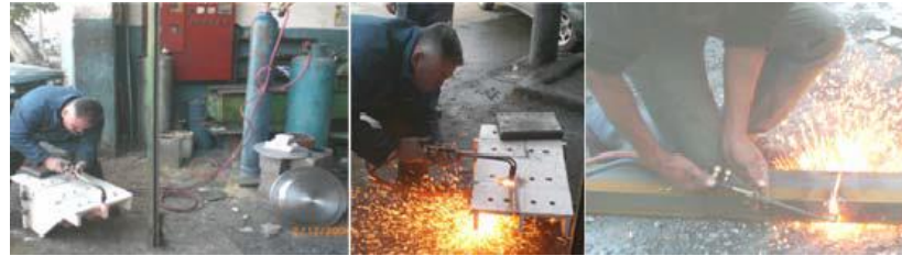
Şekil 3.4. Oksi-Asetilen kaynağı ile metal parçaların kesilmesi (Tama, 2016)
