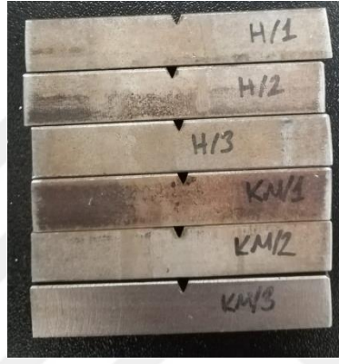
Şekil 6.17. Çentik darbe testi için hazırlanan numuneler
