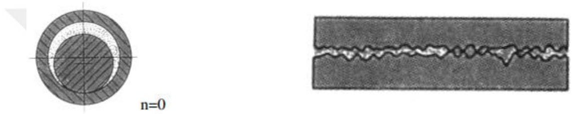
Şekil 2.10. Kuru sürtünme (Staudt, 2000).
