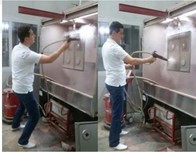
Şekil 3.3. Elektrostatik toz emaye uygulaması (Artel Özbekistan emaye tesisi, 2015)
