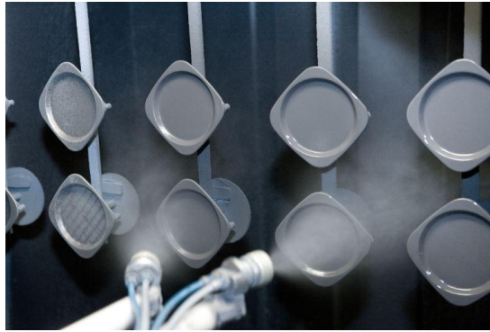
Şekil 3.6. Manuel sprey emayeleme yöntemi uygulaması (Referans: https://dcbv.com/blog/wet-enamel-application , 2019)
