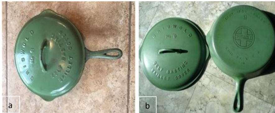
Şekil 4.6. a) Yeşil majolik emaye kaplı döküm, b) 10 kez yıkama testi sonrası
