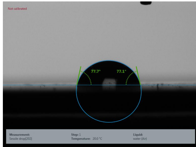
Şekil 5.7. Kahve-3 fritinin yüzey ıslatma açısı görüntüsü (Sakarya Üniversitesi – Teslab, 2019)
