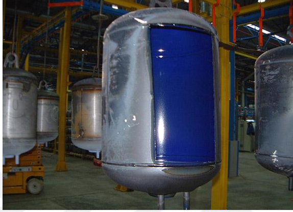
Şekil 3.8. Sıvama yöntemi ile kaplanmış bir termosifon kazanı uygulaması (Referans: https://www.newfurnace.it/the-enamel , 2019)
