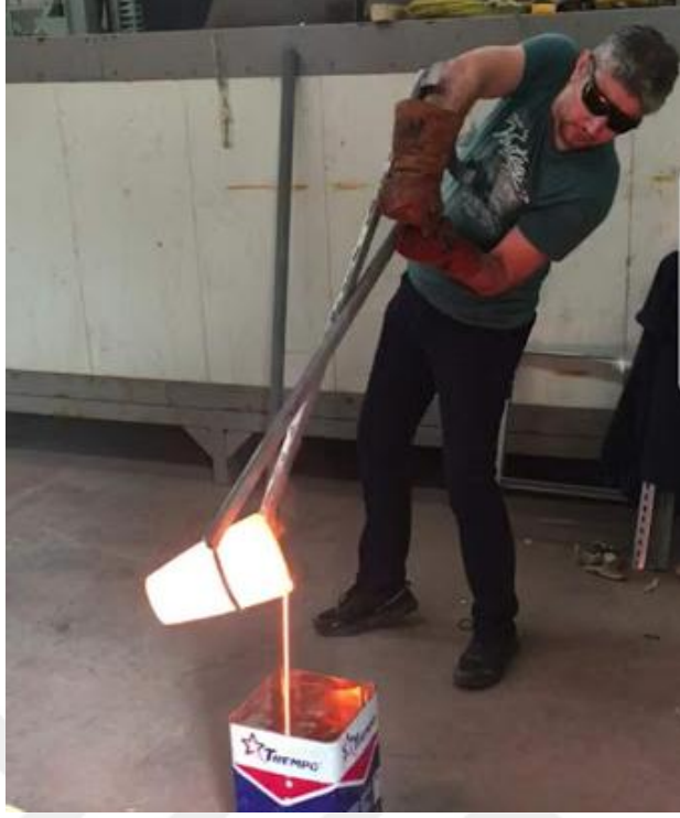
Şekil 4.3. Fritin potada ergitme sonrası suya dökülmesi (Algotrio Lab, 2019)
