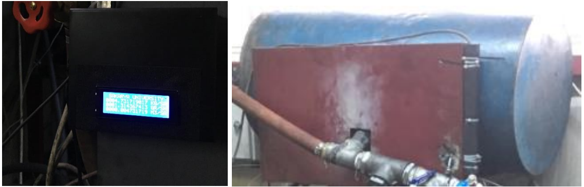
Şekil 4.9 : Hava sarfiyatı ölçüm tertibatı.
