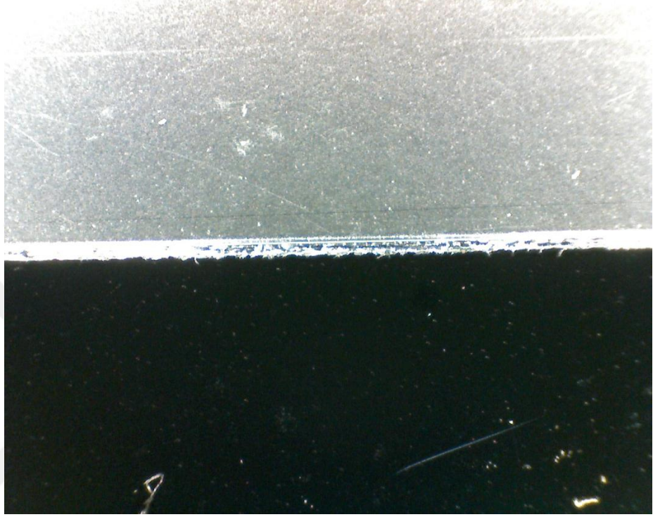
Şekil 4.4: Sıfır olarak takılan mevcut kesici ile takım ile 1. Kesim.
