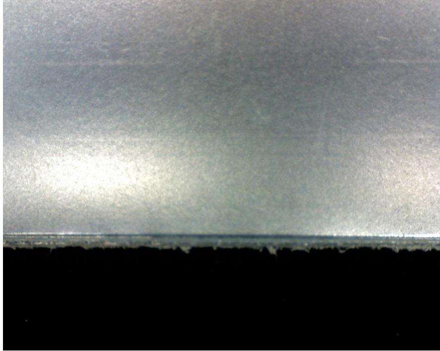
Şekil 4.6: Mevcut kesici takım ile 630 saat sonrası ve 40. kesim.
