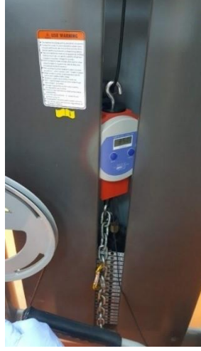
Şekil 3.1: Maksimum İzometrik Kuvvetin belirlenmesi için kullanılan modifiye edilmiş bacak dinamometresi.
