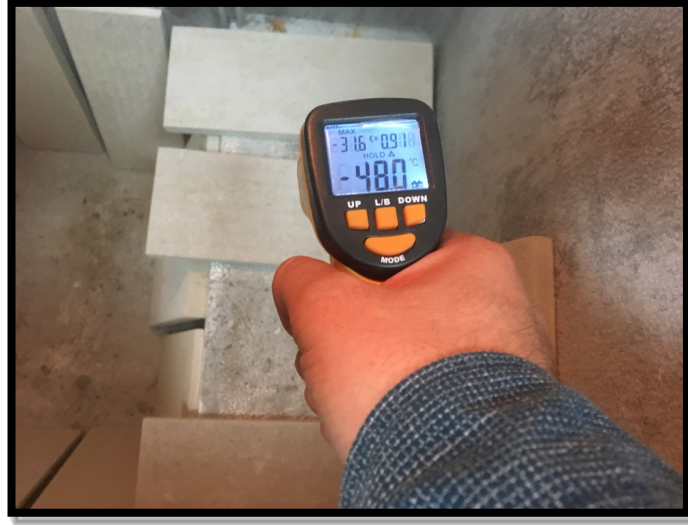
Şekil 3.6 Fibercement numunelerin yerinde ısı ölçümü
