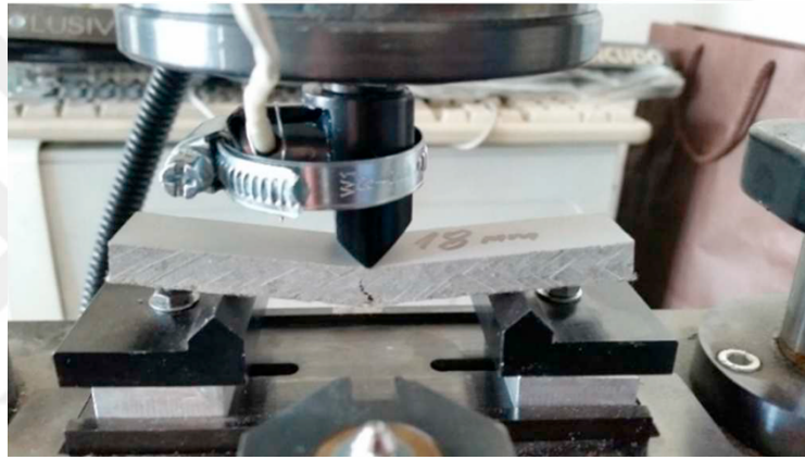
Şekil.2.12. Akustik emisyon ölçümleri yapılmış fibercement eğilme testi[18].
