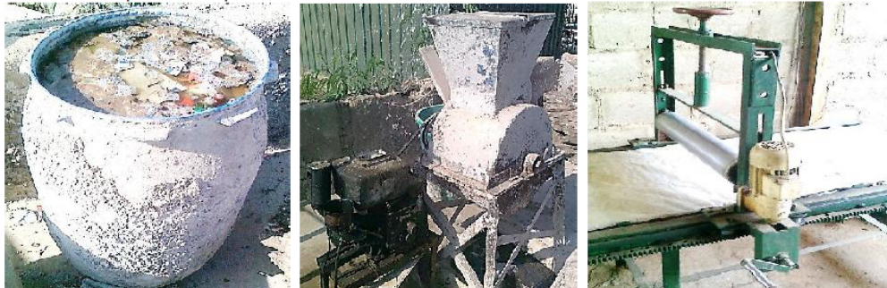
Şekil 2.22. Çalışmadaki fibercement üretimi [27].
