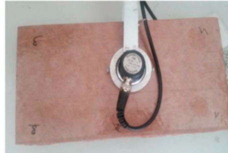
Şekil.2.11. Ultrasonik test esnasında fibercement numunesi.
