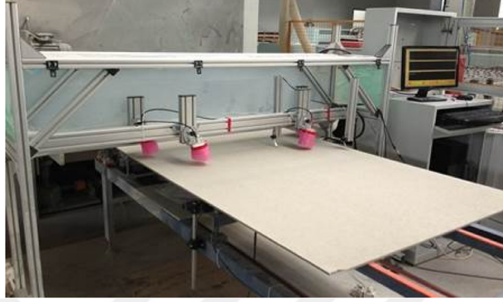
Şekil 2.18. Sabit temassız ultrason tarayıcısının görünümü [23].
