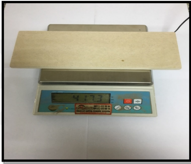
Şekil 3.3 Fibercement numunelerin deneyden önce tartılma işlemleri
