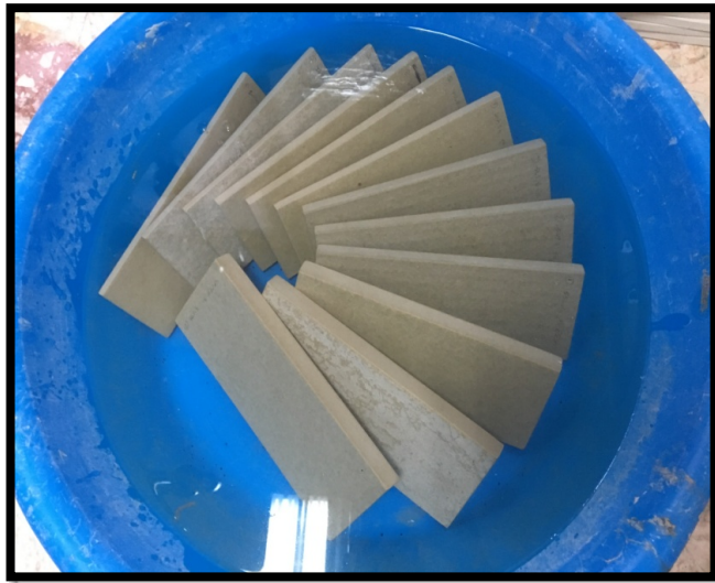
Şekil 3.4 Fibercement numunelerin deneyden önce su emme oranı tayin edilmesi
