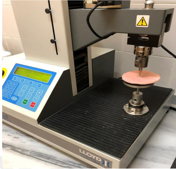
Şekil 3. 9. Push-out bağlanma testi yapılan universal test cihazı ve materyalin kanaldan uzaklaşmasını engelle karşılaşmaması için kullanılan akrilik kalıp
