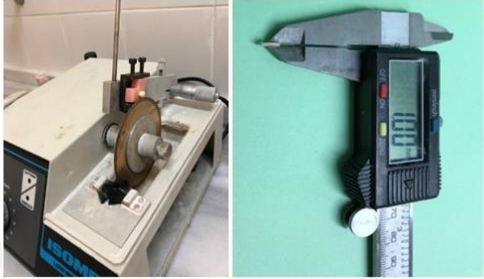
Şekil 3. 7. IsoMet cihazı ile kesit alma işlemi ve numunelerin dijital kumpasla ölçülmesi
