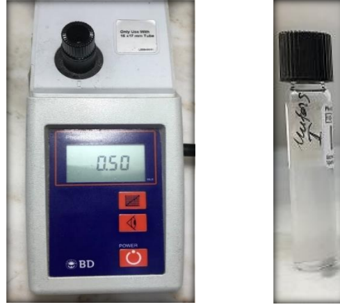
Şekil 3.14. Nefelometre cihazı ve 0,5 McFarland eşeline göre ayarlanmış S. mutans süspansiyonu.
