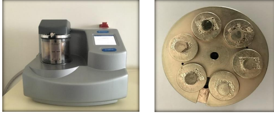
Şekil 3.12. Altın kaplama cihazı ve SEM cihazında incelenmek için altın-palladyum kaplanan örnekler.
