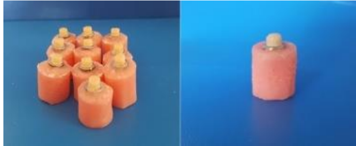
Şekil 3.36. Makaslama testi öncesi örneklerin akrilik rezine gömülmüş hali.
