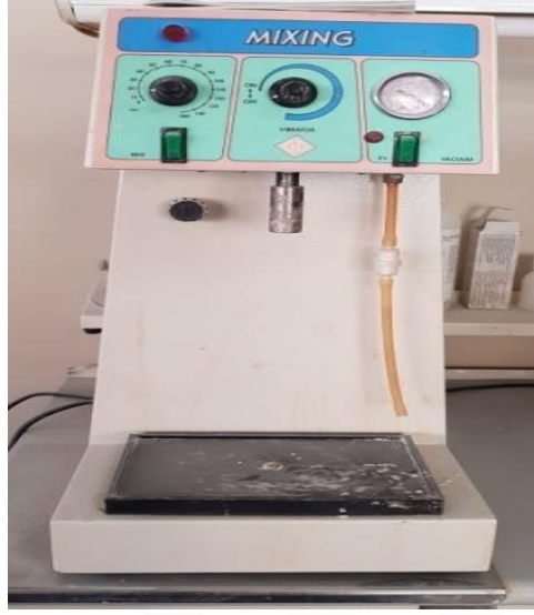
Şekil 3.6. Revetman karıştırma makinası.
