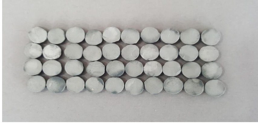
Şekil 3.16. Milleme yöntemiyle üretilmiş örneklerin kumlama işlemi sonrası görüntüsü.
