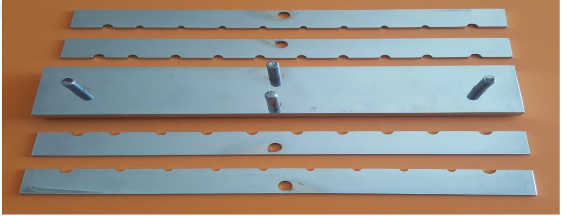
Şekil 3.22. 7 mm çapında 3 mm yüksekliğinde yuvaları hazırlanmış birinci levha.
