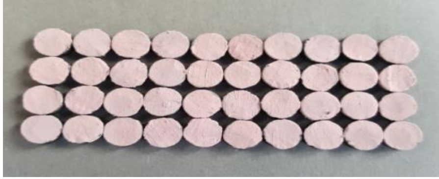
Şekil 3.18. Bond uygulanmış metal altyapıların görüntüsü.
