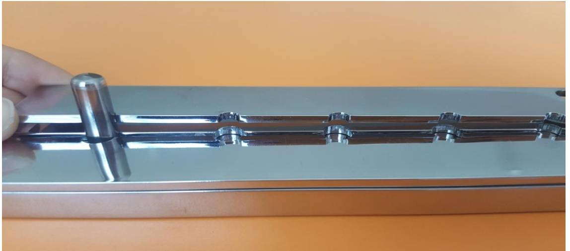
Şekil 3.23. Hazırlanan kalıbın alt ve üst levhalarının açık şekilde gösterilmesi.
