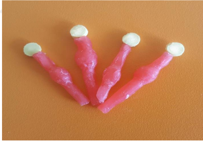
Şekil 3.5. Tij ile döküm kanalları oluşturulmuş örnekler.
