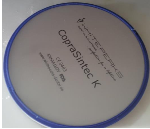
Şekil 3.12. Kobalt-Krom alaşım bloğu.
