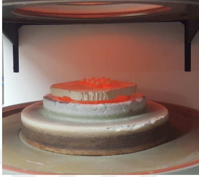
Şekil 3.30. Porselen uygulanan örneklerin porselen fırınında pişirilmesi.
