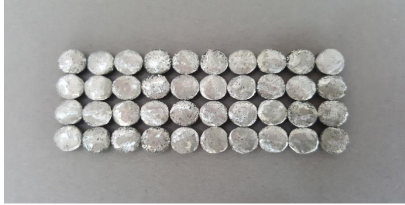
Şekil 3.11. Lazer sinterizasyonla üretilen Co-Cr metal altyapı örnekleri.
