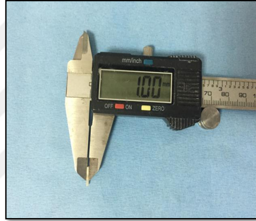
Şekil 3.6. Mikrogerilim bağlanma dayanımı test örnekleri
