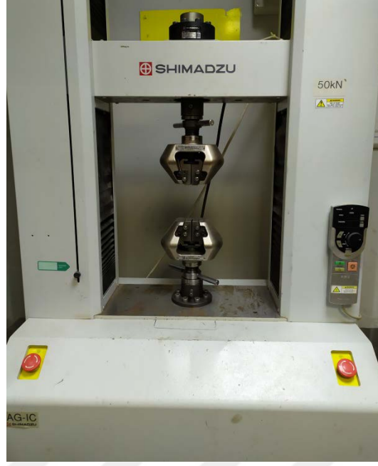
Şekil 4.14 : Çekme sıyırma, çekme makaslama ve çapraz çekme deneylerde kullanılan universal çekme cihazı.
