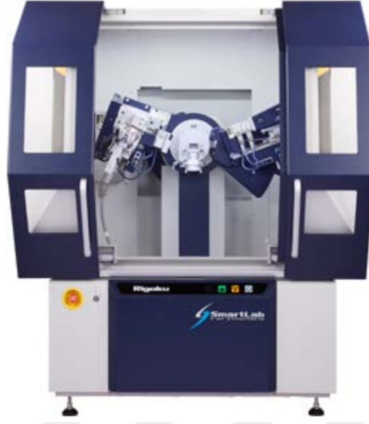
Şekil 4.13 : XRD ölçümlerinde kullanılan karakterizasyon cihazı [116].
