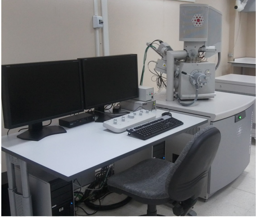
Şekil 4.12 : Taramalı Elektron Mikroskobu incelemelerinde kullanılan FESEM cihazı [115].
