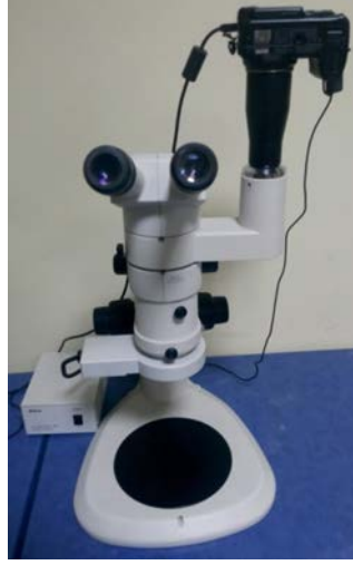
Şekil 4.9 : Makro incelemelerde kullanılan stereo mikroskop.
