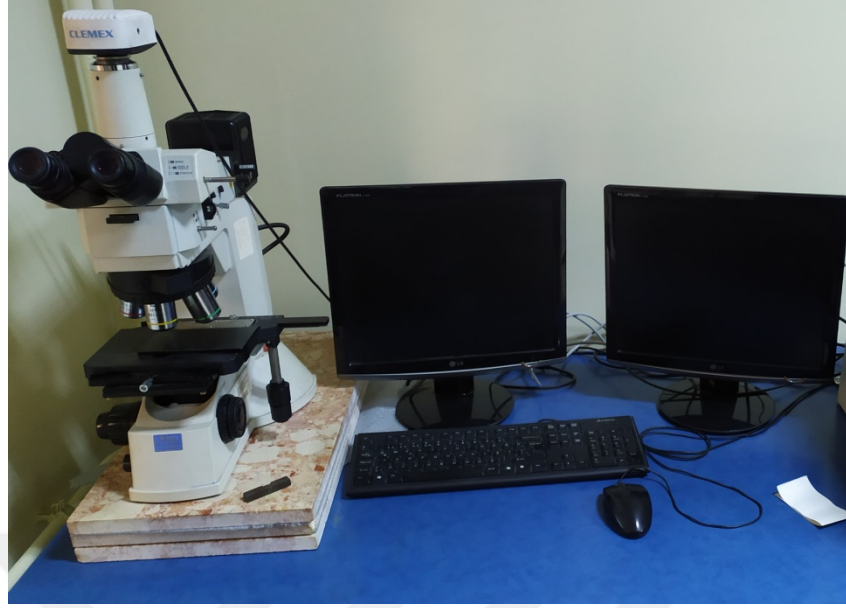
Şekil 4.8 : Mikroyapı incelemelerinde kullanılan optik mikroskop.
