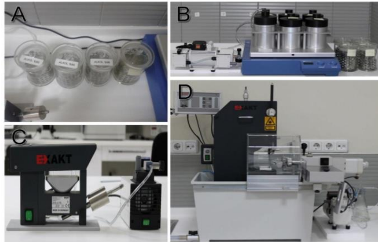
Şekil 5 11. Histomorfometrik Analiz Yöntem Basamakları, A) Örneklerin dehidrate edilmesi için kullanılan alkol solüsyonları, B) Dehidrate edilen örneklerin infiltre edilmesinde kullanılan teknovit solüsyonları, C) Örnekleri içeren metil metakrilat rezin blokların lam üzerine vakum altında yapıştırılması, D) Örneklerden kesit almak için kullanılan Exakt sert doku kesme cihazı
