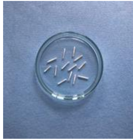
Şekil 3.18. Kesit alma cihazında dişin uzun aksına paralel enine ve boyuna kesitler alınmış hali ve elde edilen test çubukları
