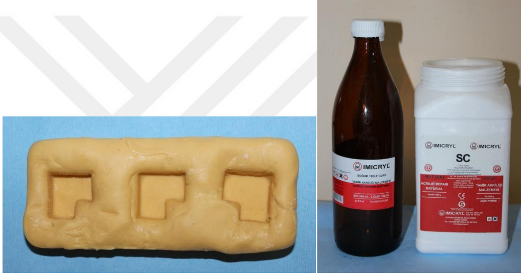
Şekil 3.13. “L” şeklindeki silikon kalıp ve otopolimerizan soğuk akril
