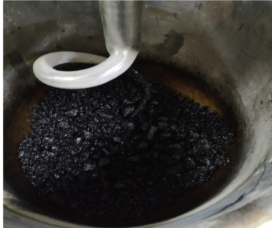
Şekil 5.13 Düşük sıcaklıkta karışımı sağlanan asfalt numunesi
