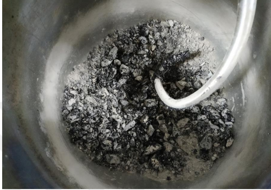
Şekil 5.12 Katkısız düşük sıcaklıkta karışımı sağlayan asfalt numunesi
