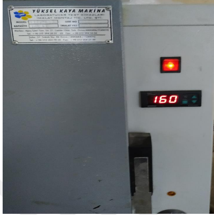
Şekil 5.10 Referans numuneler için etüv sıcaklığı
