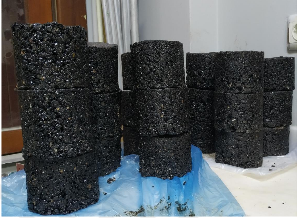
Şekil 5.23 Marshal deneyi yapılan asfalt numuneler
