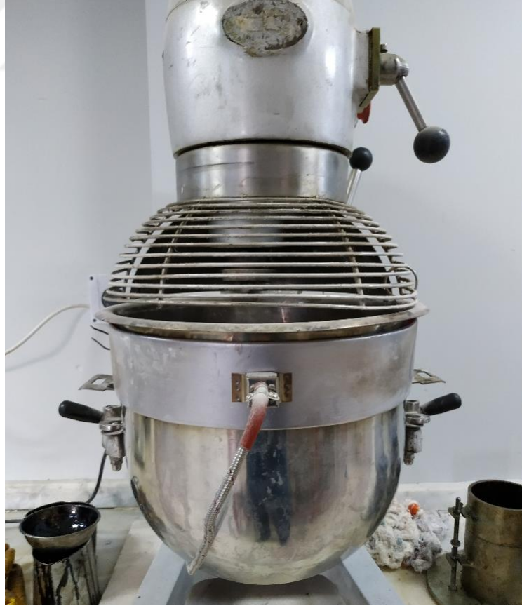
Şekil 5.11 Karışım için kullanılan rezistanslı mikser
