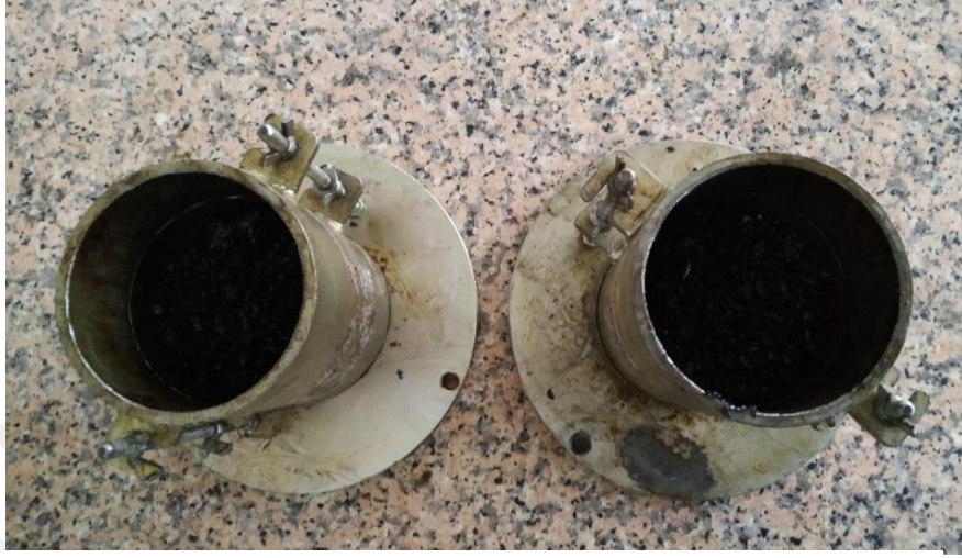
Şekil 5.3 Asfalt betonu ve kalıpları
