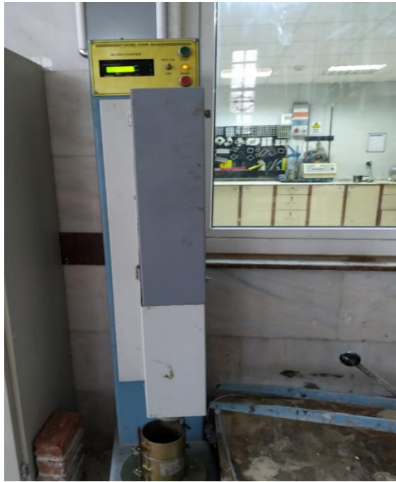
Şekil 5.4 Asfalt sıkıştırmak için kullanılan proktor cihazı
