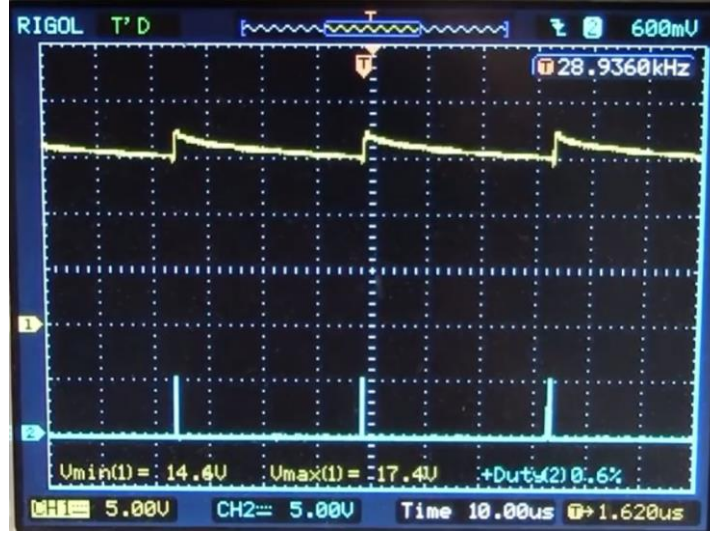
Şekil 4.28 : V_B=12V , I_B=55A , R_B=4m\Omega özelliklerine sahip akünün AKC tepkisi osilaskop çıktısı.
