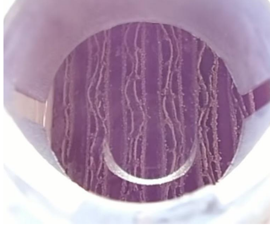
Şekil 4.37 : Test için kullanılan akünün test öncesi bir hücredeki durumu ( V_B=12V , I_B=55A , R_B=13.5\Omega ).
