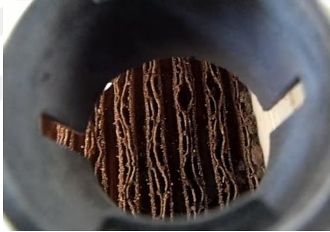
Şekil 4.38 : Test için kullanılan akünün test sonrası bir hücredeki durumu ( V_B=12V , I_B=55A , R_B=13.5\Omega ).
