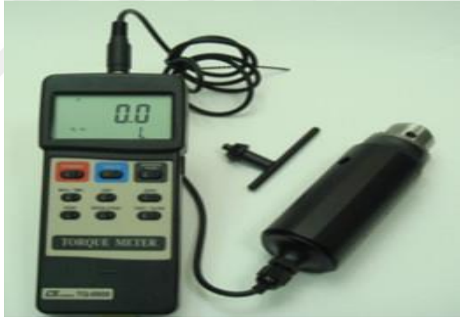
Şekil 3 14. Kullanılan çıkarma tork cihazı
