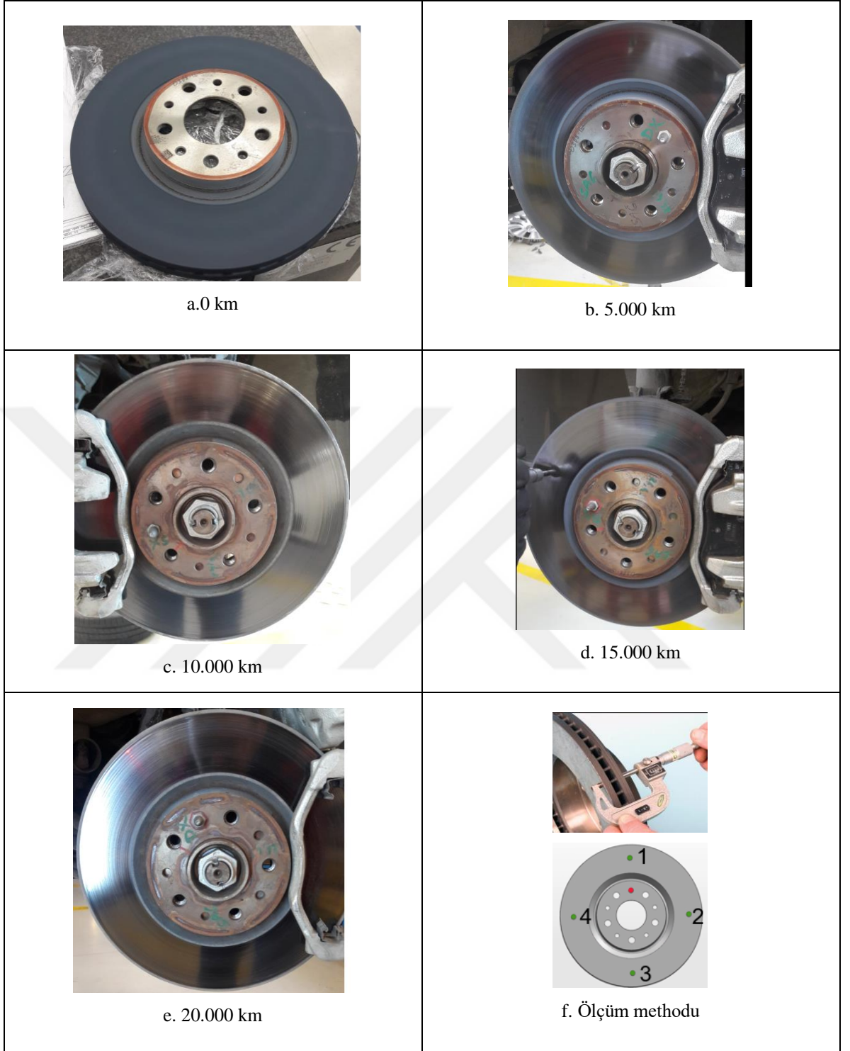
Şekil 7.13 : Araç üzerinde kaplamalı disk üzerinde et kalınlığı ölçümü ve görsel kontrol (toplam 20.000 km).
