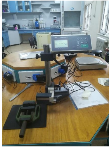
Şekil 6.5 : Yüzey pürüzlülük ölçüm cihazı.
