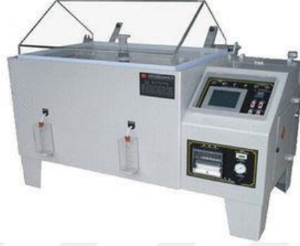
Şekil 6.10 : Tuz püskürtme test cihazı.
