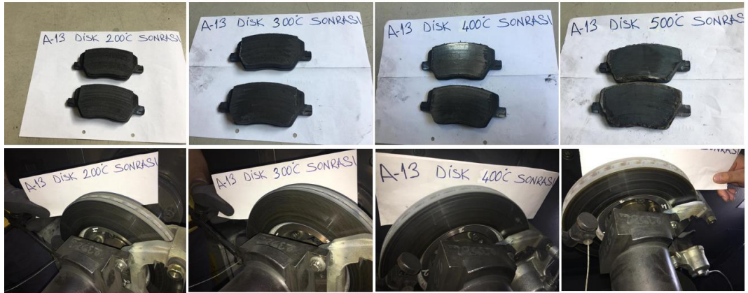
Şekil 7.19 : Kaplamalı disk üzerinde dinamometre testi sonrasında disk ve balata malzeme yüzeylerinin görünümü.
