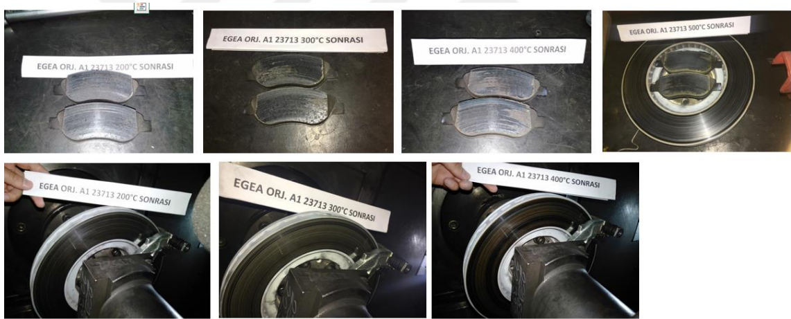
Şekil 7.20 : İnce kaplamalı disk üzerinde dinamometre testi sonrasında disk ve balata malzeme yüzeylerinin görünümü.
