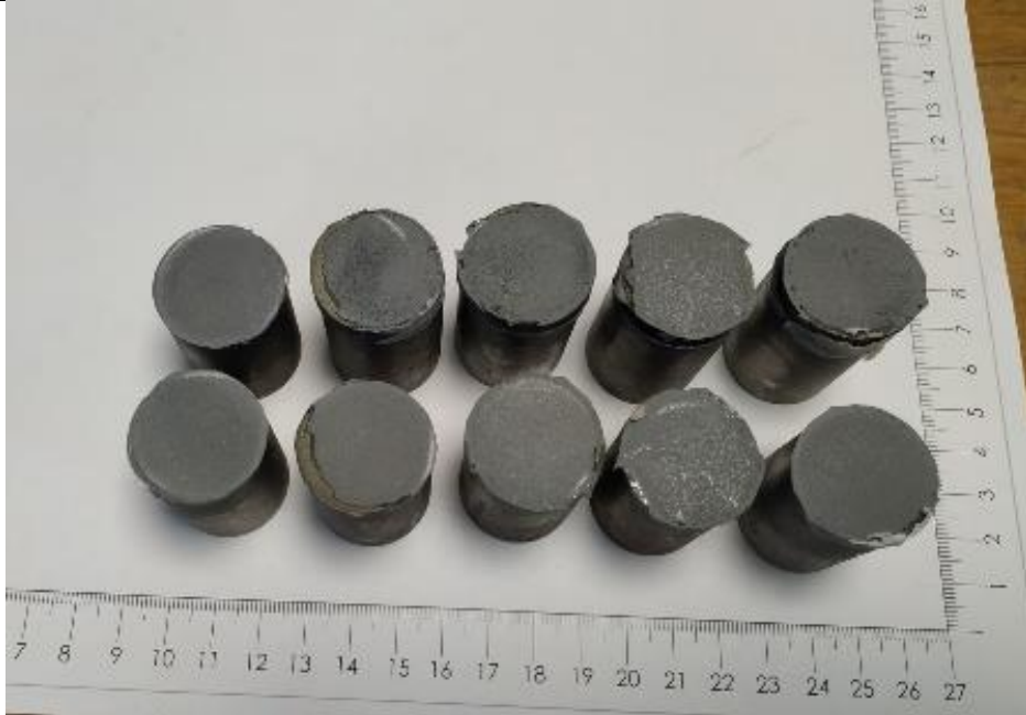
Yapışma testi yapılmış numuneler
