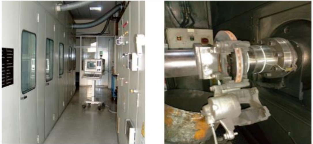
Şekil 6.9 : Dinamometre testi cihazı.
