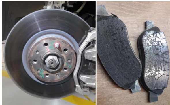
řekil 7.15 : Kaplamalı disk üzerinde 20.000km test sürüřü sonrasında disk yüzeyi ve balataların görüntüsü.
