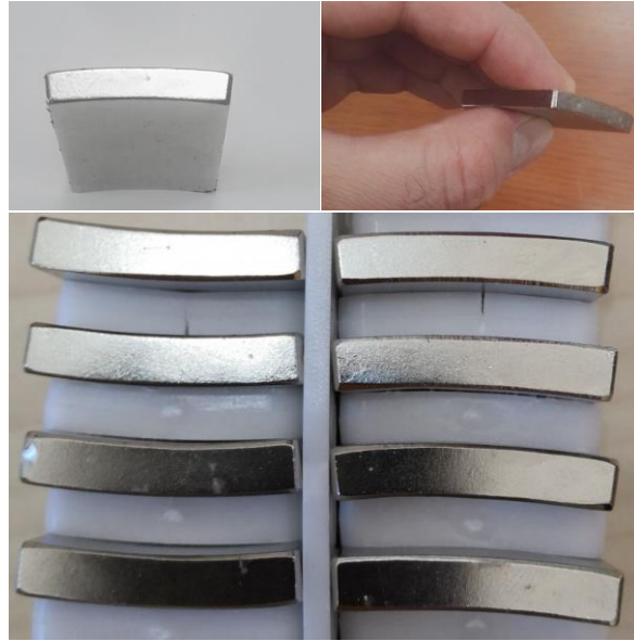
Şekil 3.13. Prototip motorda kullanılan N45SH tipi eğri mıknatıslar
