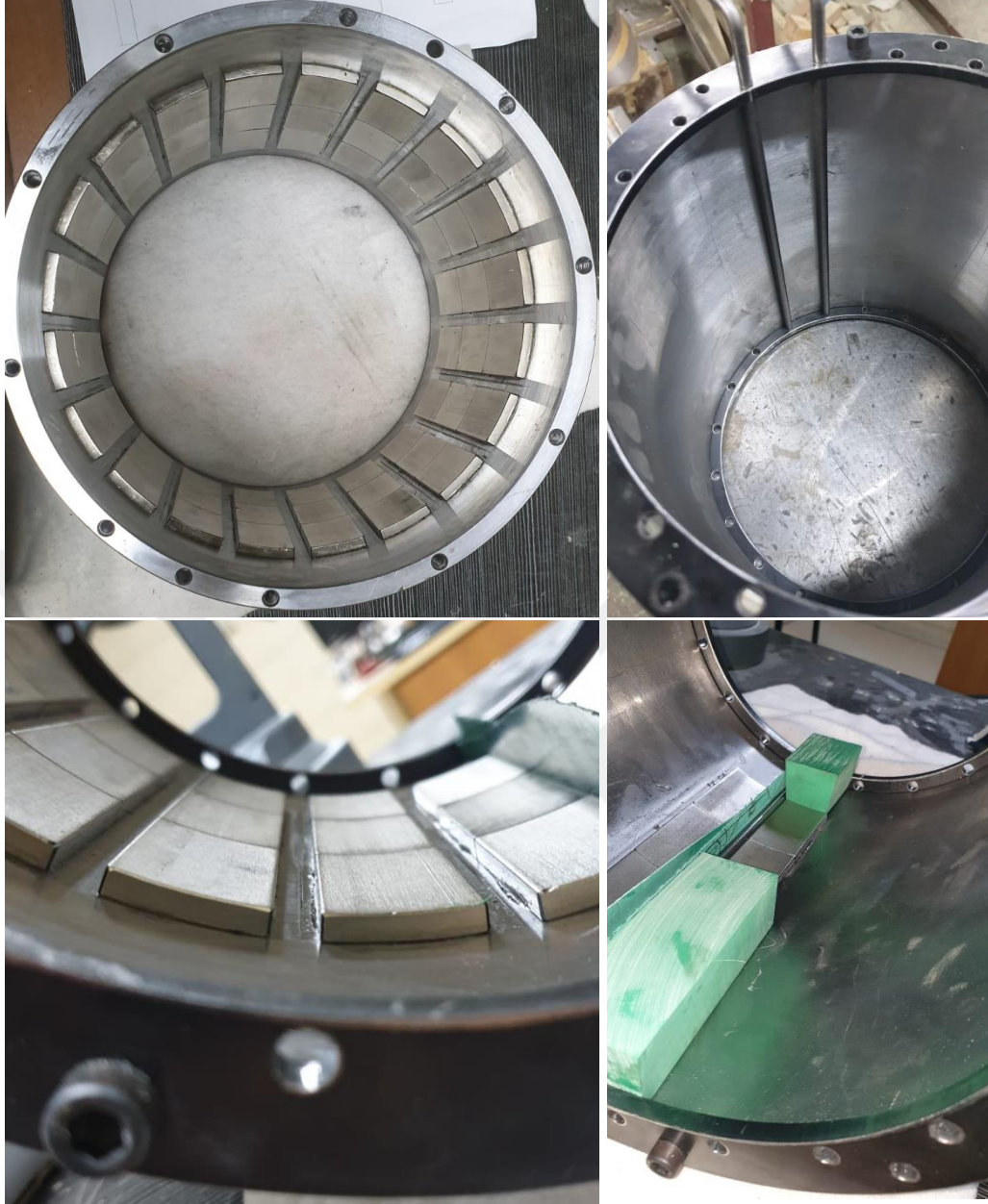
Şekil 3.10. Rotor ve mıknatısların rotor üzerine yapıştırılma aşamaları
