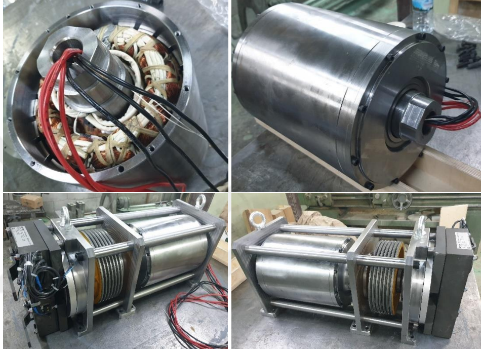
Şekil 4.31. Dıştan rotorlu SMSM’nin montaj resimleri
