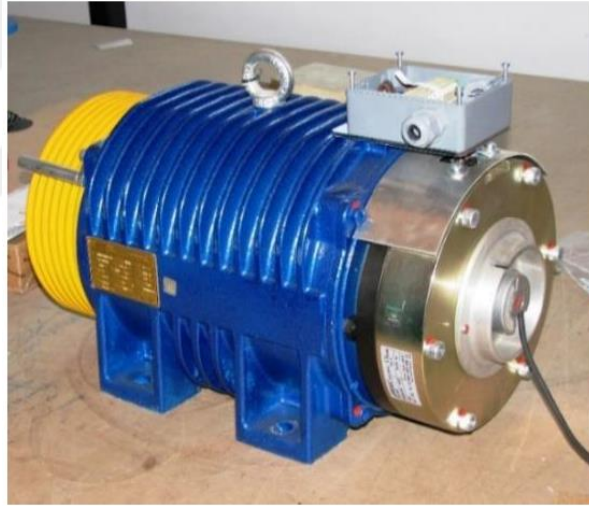
Şekil 1.10. Karşılaştırma motoru olarak kullanılan içten rotorlu SMSM (Bakhtiarzadeh 2017)
