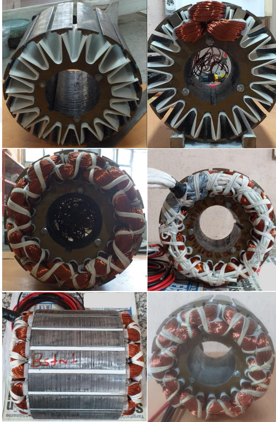
Şekil 3.9. Çift katmanlı sarım yapılmış stator paketi
