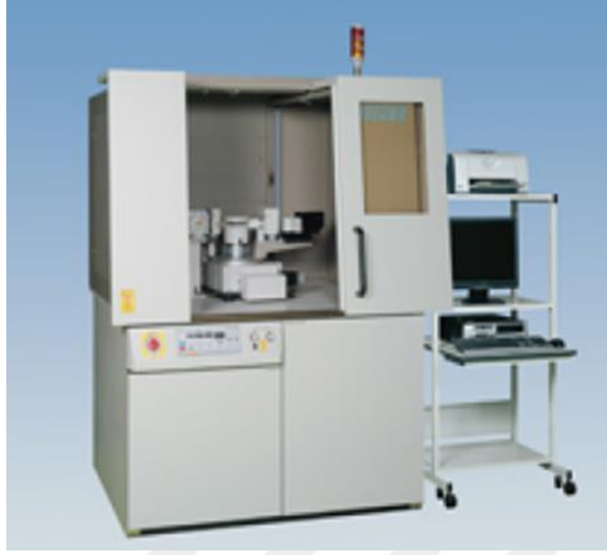
Şekil 4.13: Rigaku D/MAX 2000 marka X-ışınları difraktometresi
