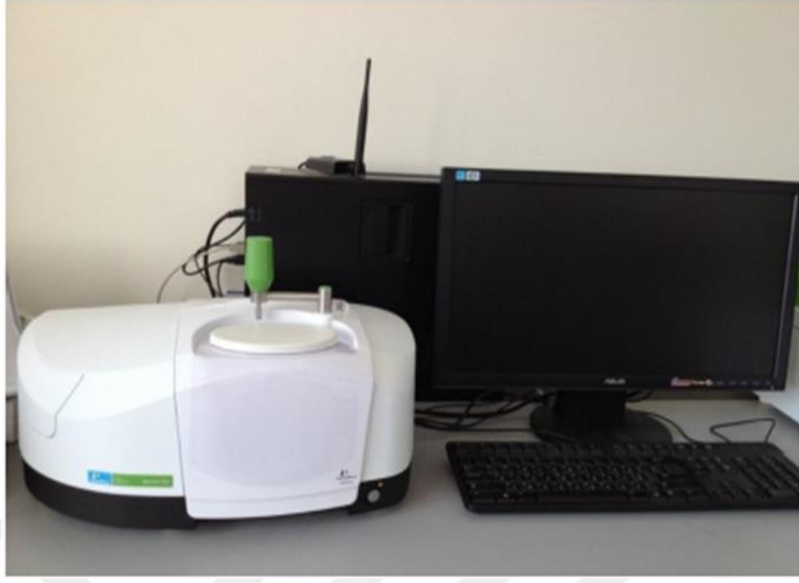
Şekil 4.15: Perkin Elmer Spectrum 100 marka FTIR cihazı.
