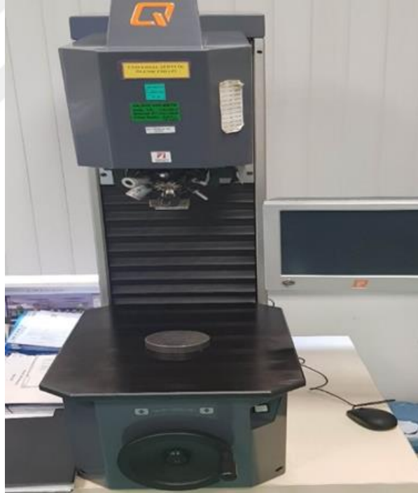
Şekil 4.7: QNESS marka Q750M Modelli çok fonksiyonlu Sertlik ölçme cihazı
