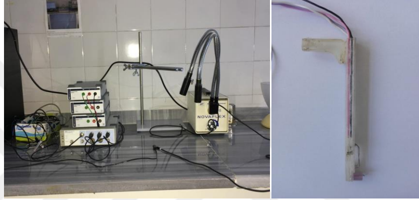
Şekil.17. Elektrofizyolojik değerlendirmenin yapıldığı amplifikatör, stimülatör ve platin prob
