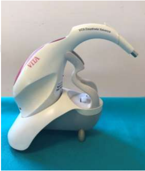
Şekil 3.11. Dişlerin renk ölçümünde kullanılan VITA Easyshade Compact (VITA Zahnfabrik, Bad Säckingen, Almanya) spektrofotometre cihazı.
