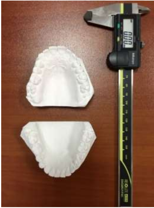
Şekil 3.5. Alçı modeller üzerinde yapılan ölçümlerde kullanılan dijital kumpas (Absolute Digimatic Caliper Series 500, Mitutoyo Corporation, Japonya).
