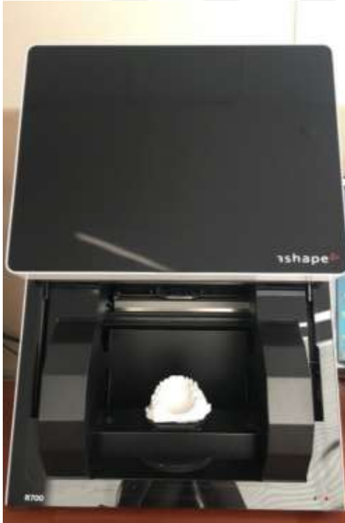
Şekil 3.3. 3Shape R700 (3Shape, Kopenhag, Danimarka) model tarama cihazı.
