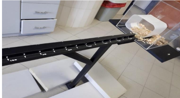
Resim 37: Bařlangıcından sonunda dođru giderek daralan, zerinde mesafe iřaretleri bulunan Tapered-Beam Walking yrme dzeneđinin yakından grnm
