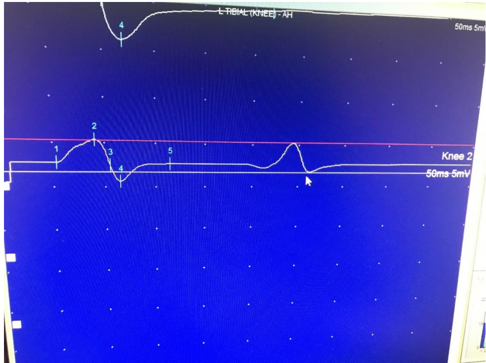
Resim 3.2. H refleks amplitüdünün tepeden tepeye ölçülmesi
